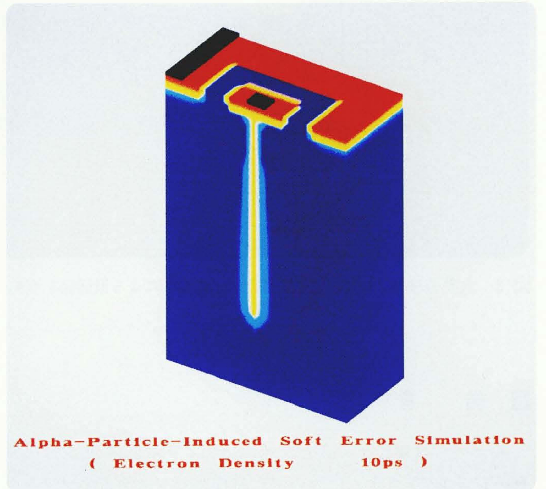
図15 メモリセルのアルファ線ソフトエラー解析 カラーの濃淡によって、垂直入射したアルファ線により生成された電子密度を表示している。
