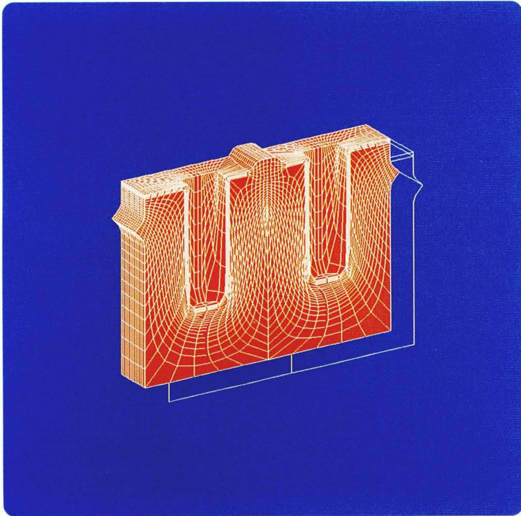
図14 メモリセルのメッシュ分割図 バウンダリーフィット法による分割技術によって、電流密度の高くなる部分に集中して滑らかなメッシュを生成している。
