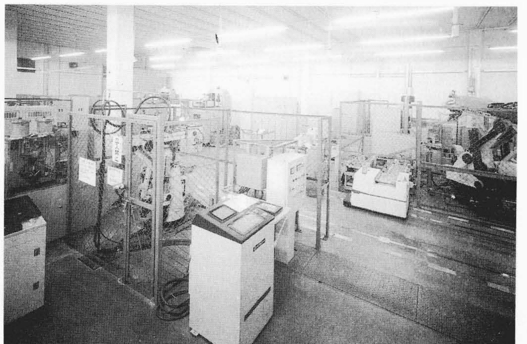
図9 自動試験ライン 無人台車、ロボット、各種自動試験機などで構成し、完全自動処理をする。
