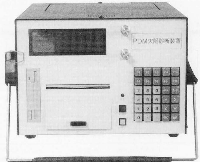
図16 PDM欠陥診断装置 16ビットのマイクロコンピュータを内蔵したPDM欠陥診断装置の外観を示す。
