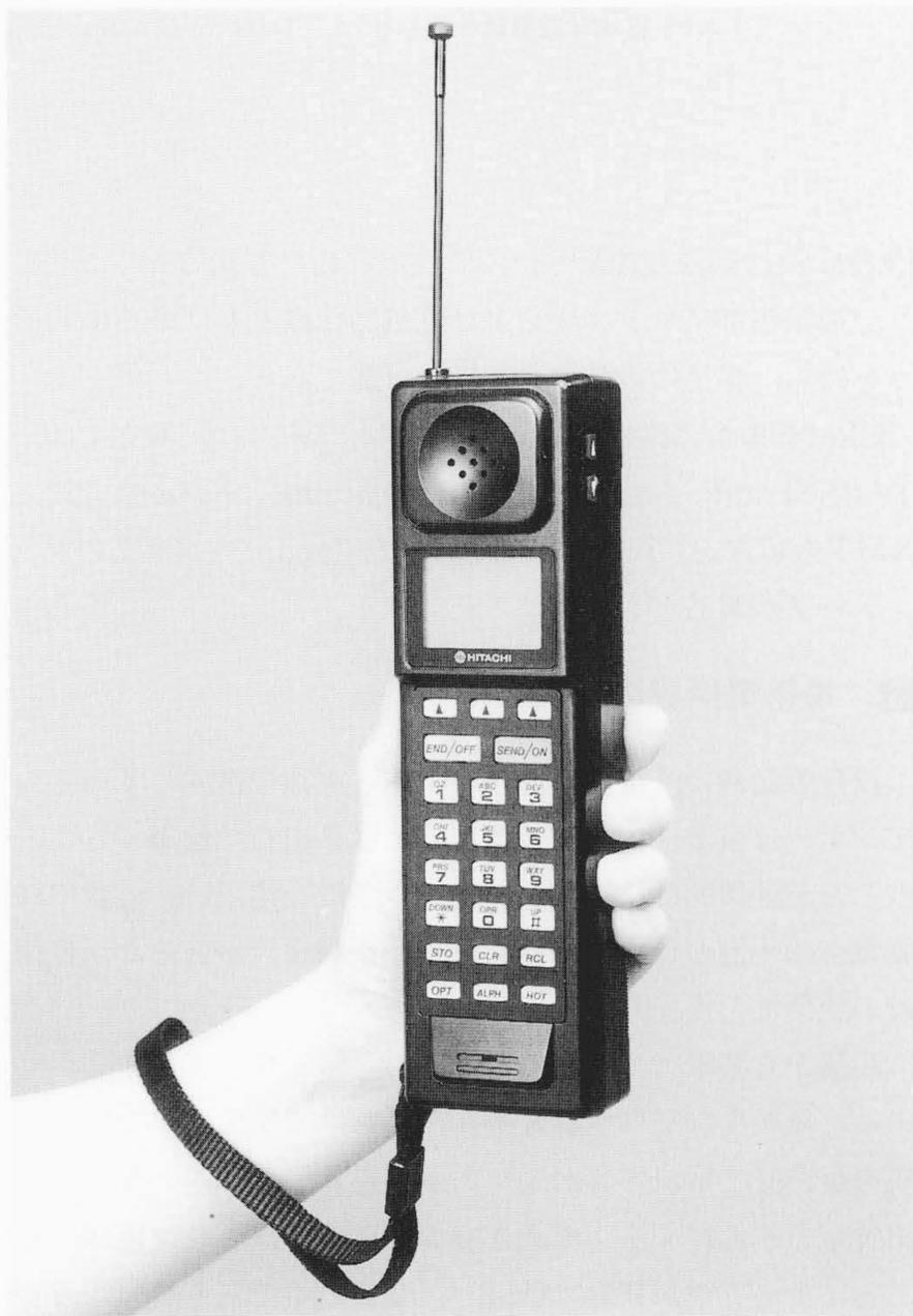
図1 携帯電話機CR-2000の外観 片手で容易に操作可能な小形形状である。空中線は、使用しない場合は装置内に押し込むことができる。
