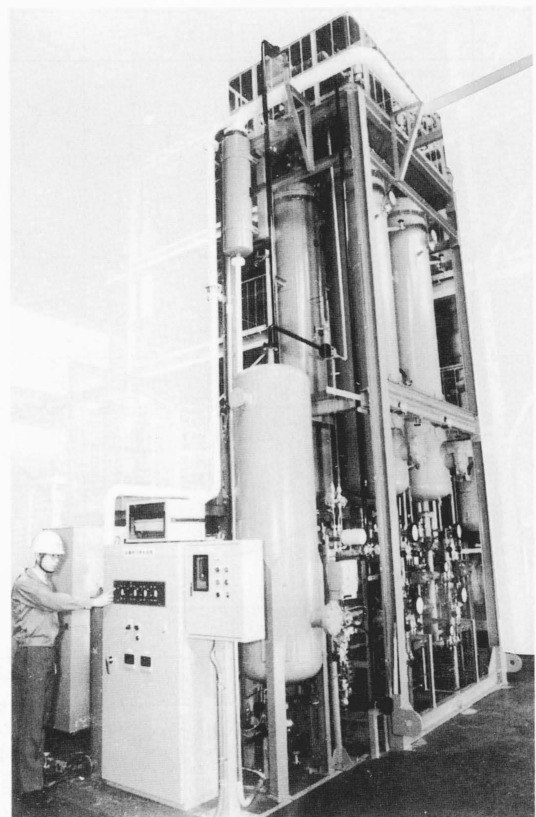
図4 酸素PSAパイロットプラント 基本構成は4塔式プロセスであり、2塔式および3塔式プロセスの検討も可能である。酸素発生量40 Nm<sup>3</sup>-O<sub>2</sub>/h規模装置である。
