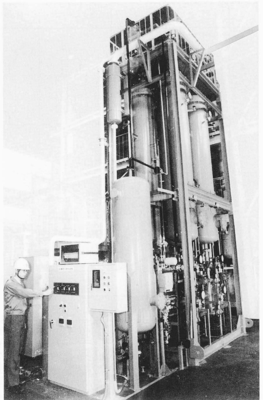
図4 酸素PSAパイロットプラント 基本構成は4塔式プロセスであり、2塔式および3塔式プロセスの検討も可能である。酸素発生量 $40 \text{ Nm}^3\text{-O}_2/\text{h}$ 規模装置である。
