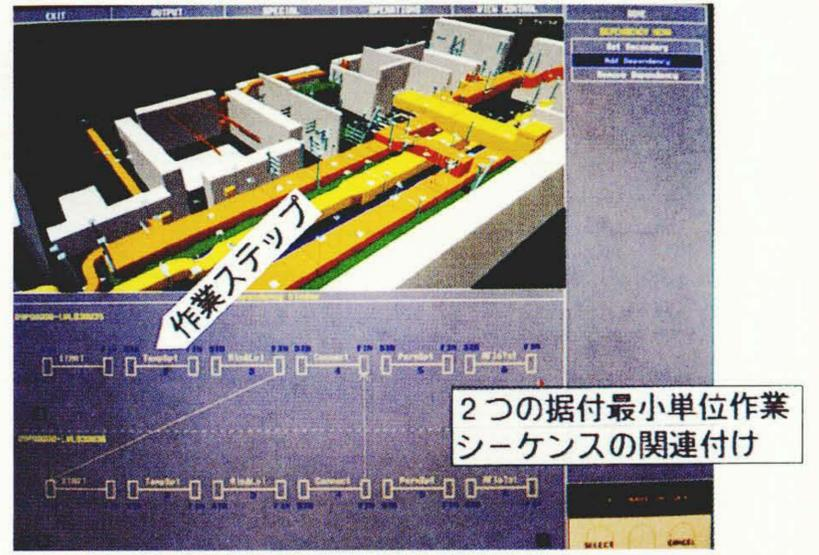
図10 作業ネットワーク定義機能 二つの据付け最小ユニット間の作業シーケンスの関連づけを対話で行うが、矛盾した関連づけは自動的に警告される。
