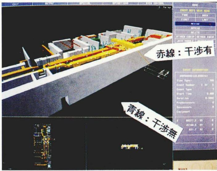
図9 干渉チェック機能 据付け物を設定位置へ移動させたとき、軀(く)体との干渉が発生(赤ラインが干渉経路)する。
