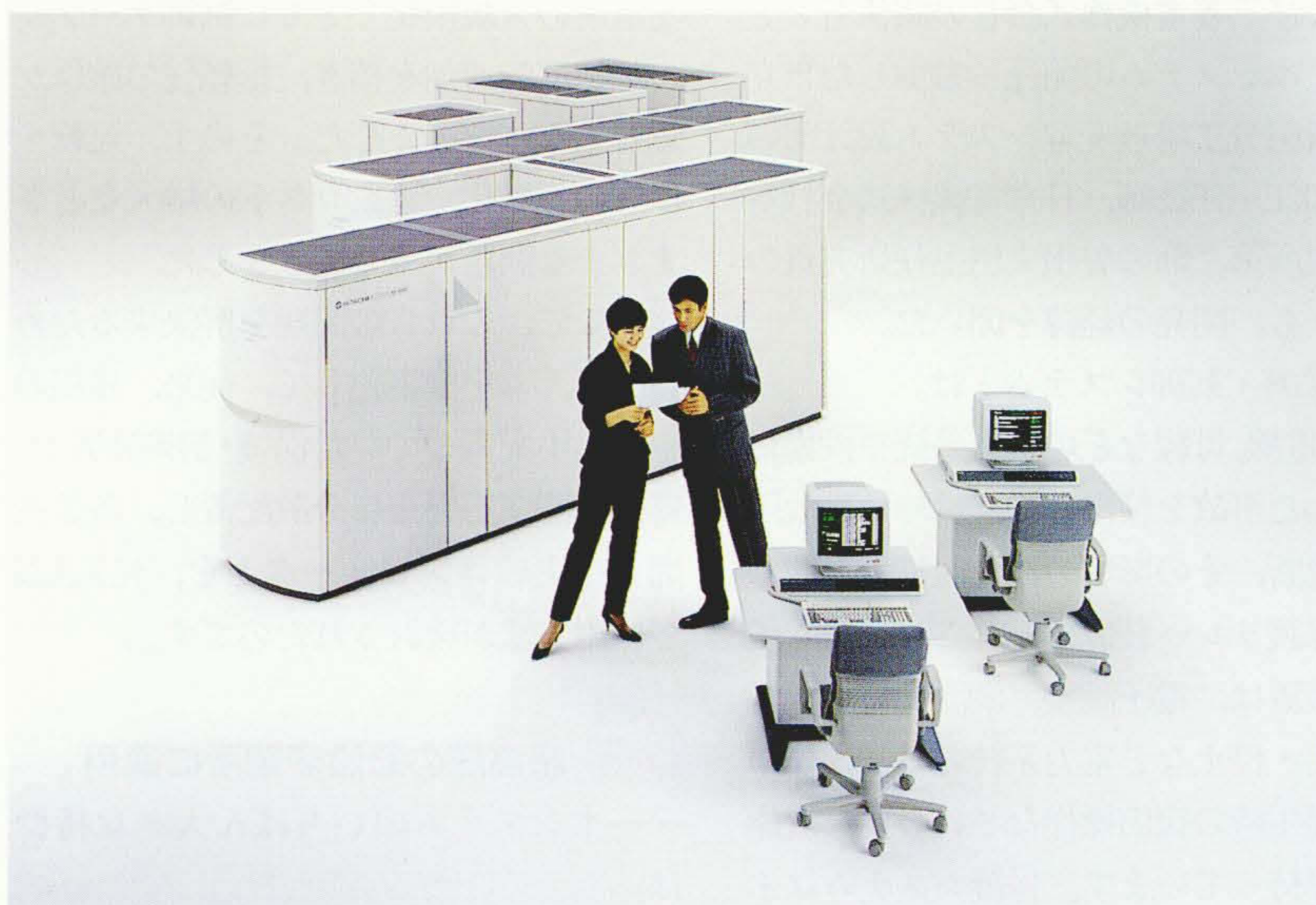
4台の命令プロセッサから構成されるHITAC M-880 / 420 (4ウェイプロセッサモデル)
