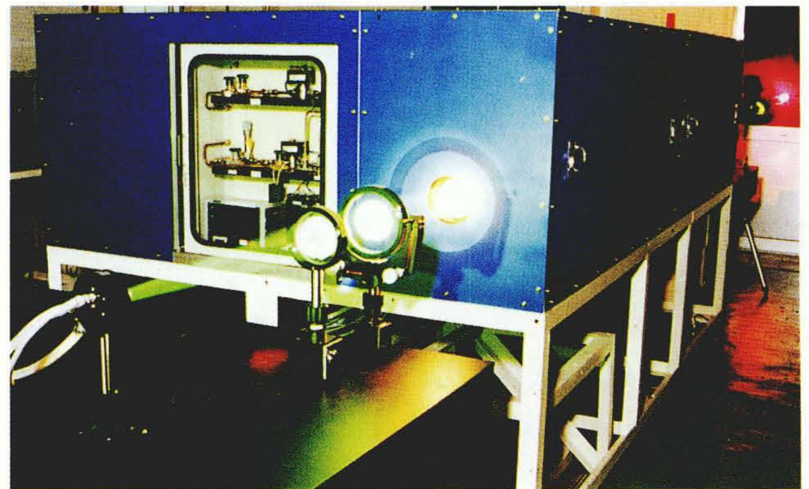
銅蒸気レーザシステム試験状況
