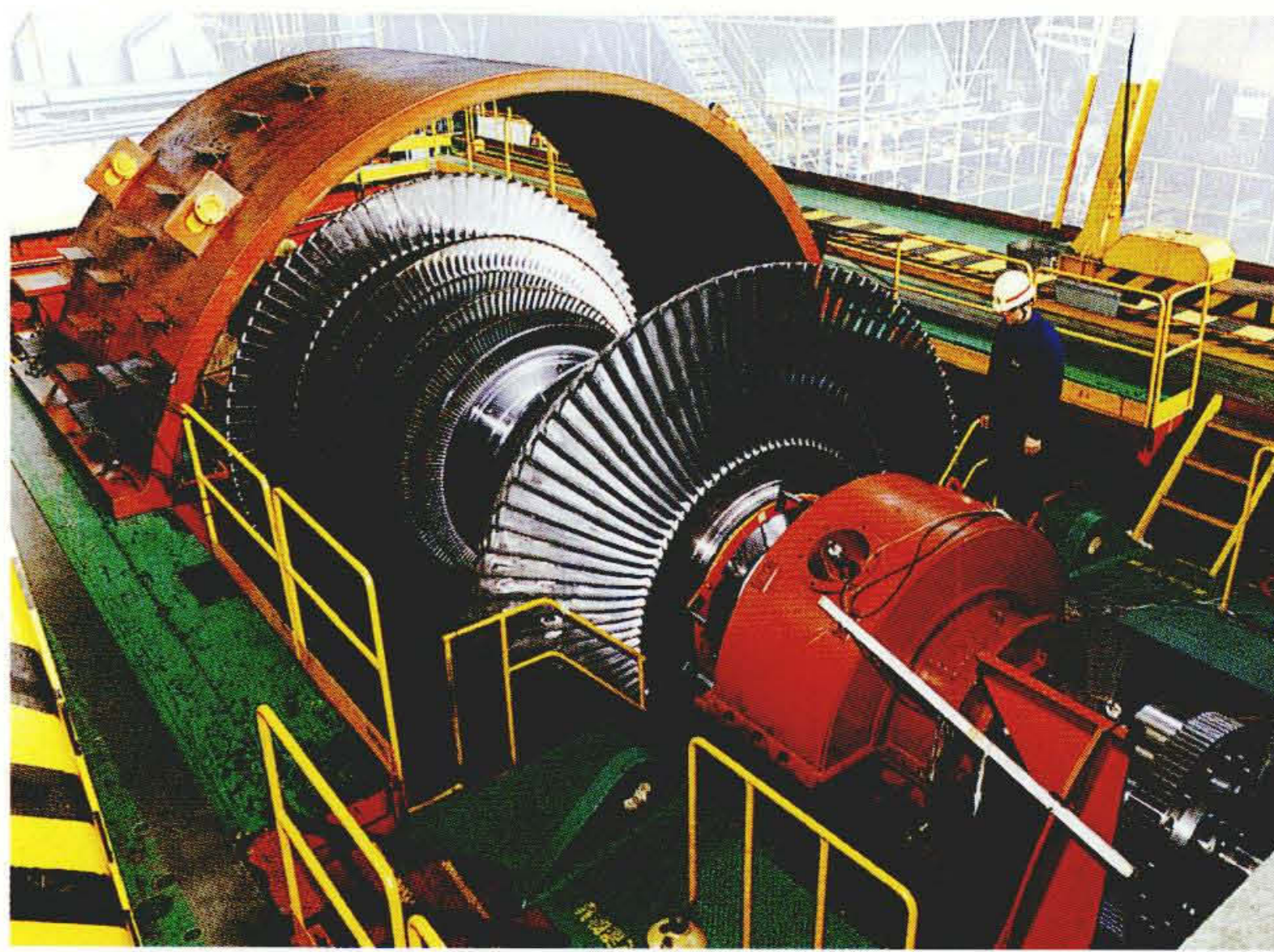
高速ダイナミックバランス試験中の低圧ロータ
