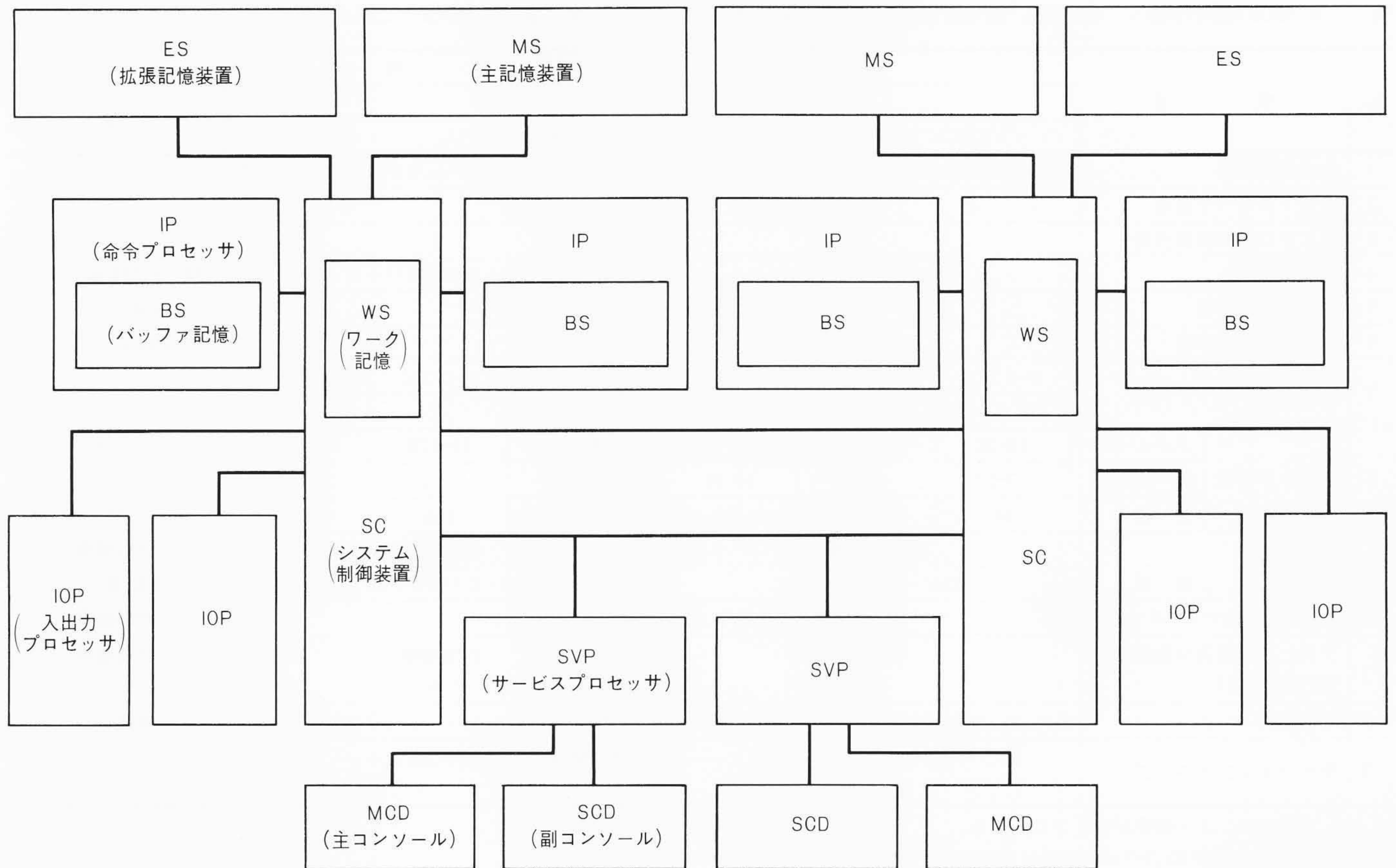
図2 M-880/420のシステム構成 M-880/420は4台のIP(命令プロセッサ)、4台のIOP(入出力プロセッサ)、最大2 GバイトのMS(主記憶装置)、最大8 GバイトのES(拡張記憶装置)、256台のチャンネルなどで構成できる。
