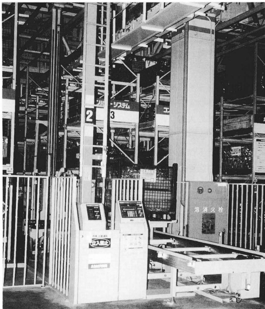
図2 ソートラック 素材や部分品を収納する648棚の自動倉庫を示す。
