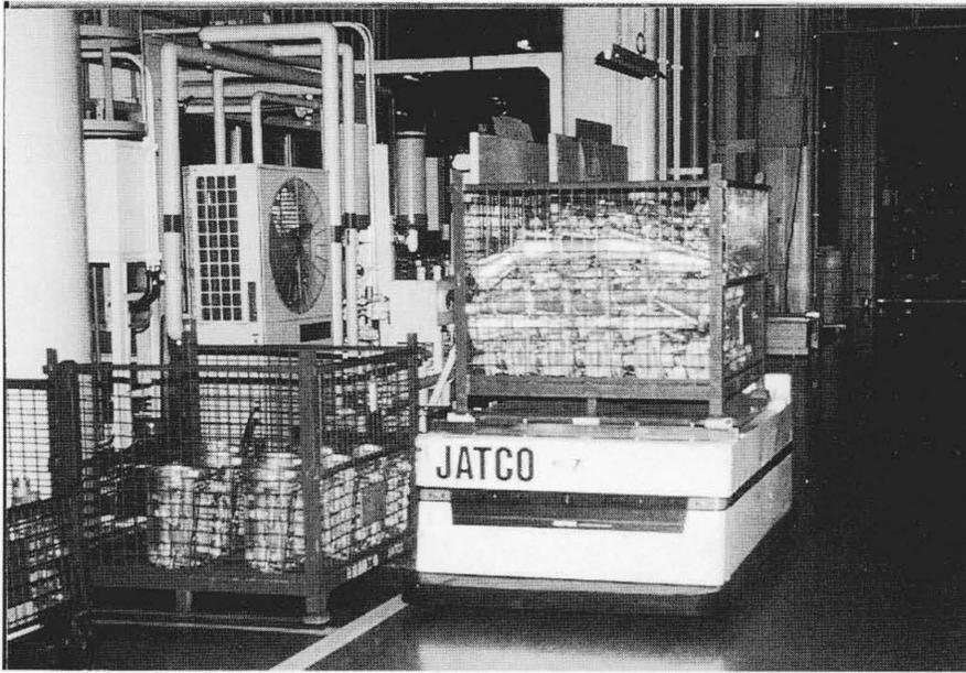
図4 無人搬送車 各工程間の搬送を26台の無人搬送車で自動化している。
