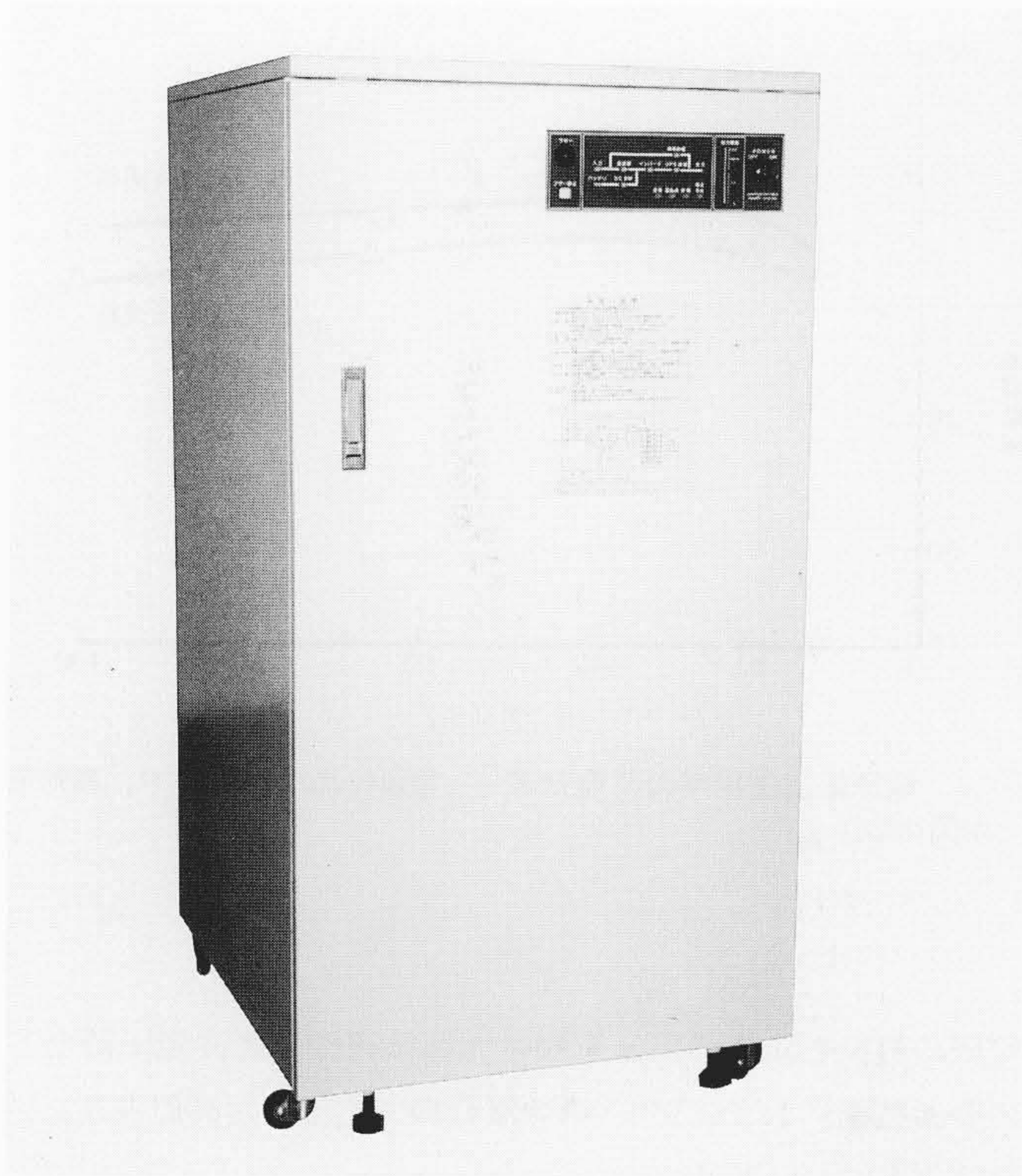
図9 試作CVCVFの外観 試作した単相10 kVAの高周波リンク式CVCVFの外観を示す。
