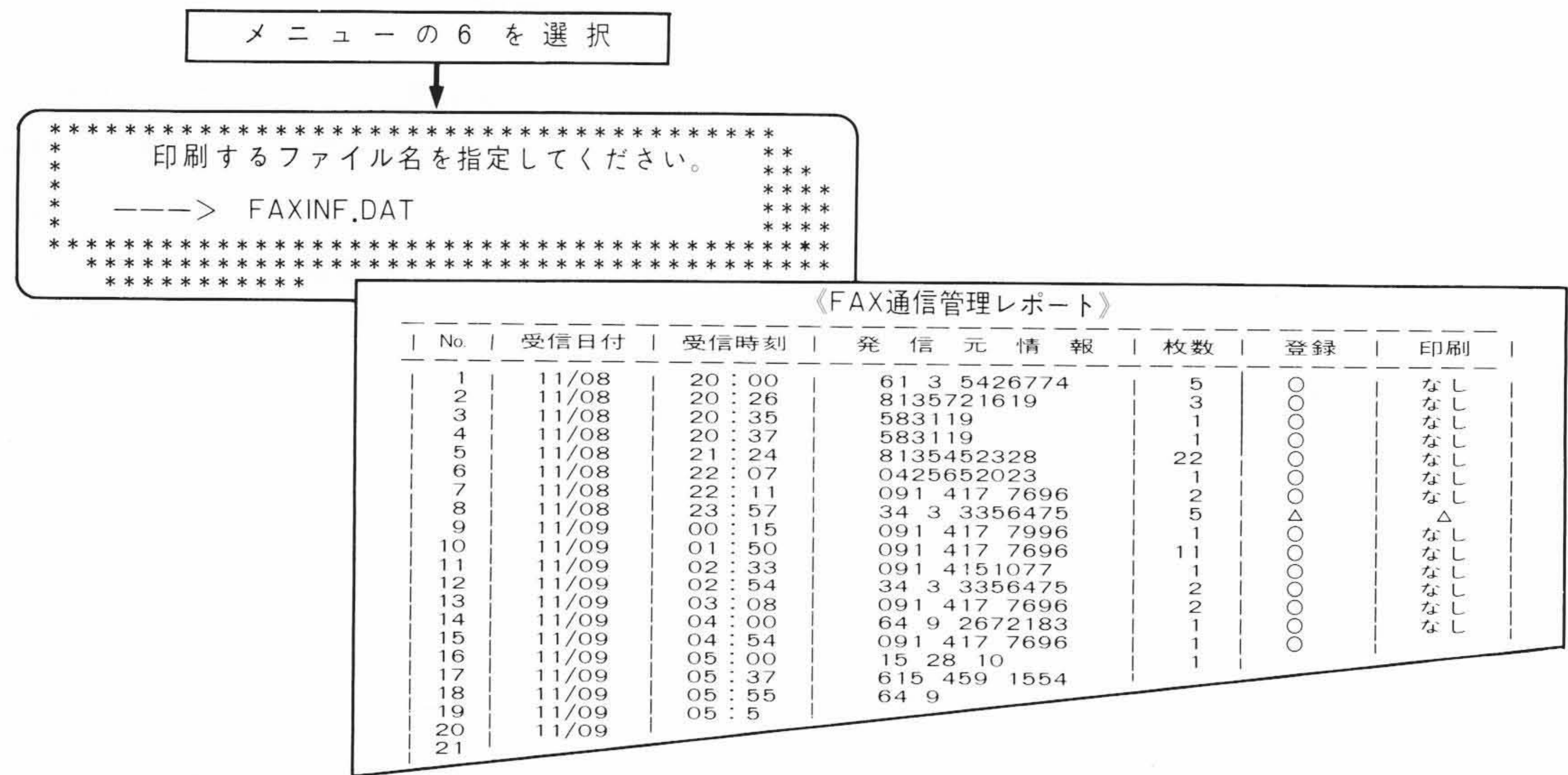
図4 通信管理レポート 通信管理レポートの印刷例を示す。受信日付、受信時刻、発信元情報に加え、登録枚数、登録・印刷の可否が出力できる。登録、印刷の欄には、正常に登録できた場合は“○”を、回線状態が不良の場合は“△”を印刷する。また、印刷の欄の“なし”は、受信時の印刷を指定しなかった場合である。
