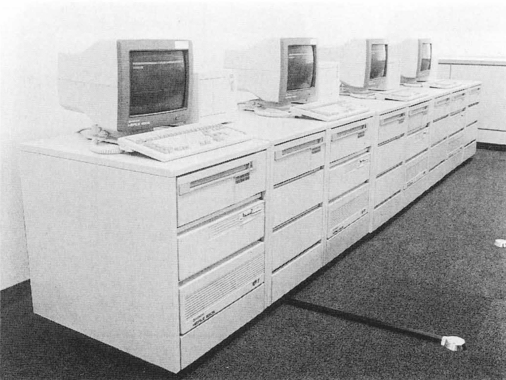
図4 ファイルステーションの外観 4台の12インチファイルステーションでは12台の駆動装置が稼動する。うち1台に12インチ光ディスクライブラリ装置が接続されている。
