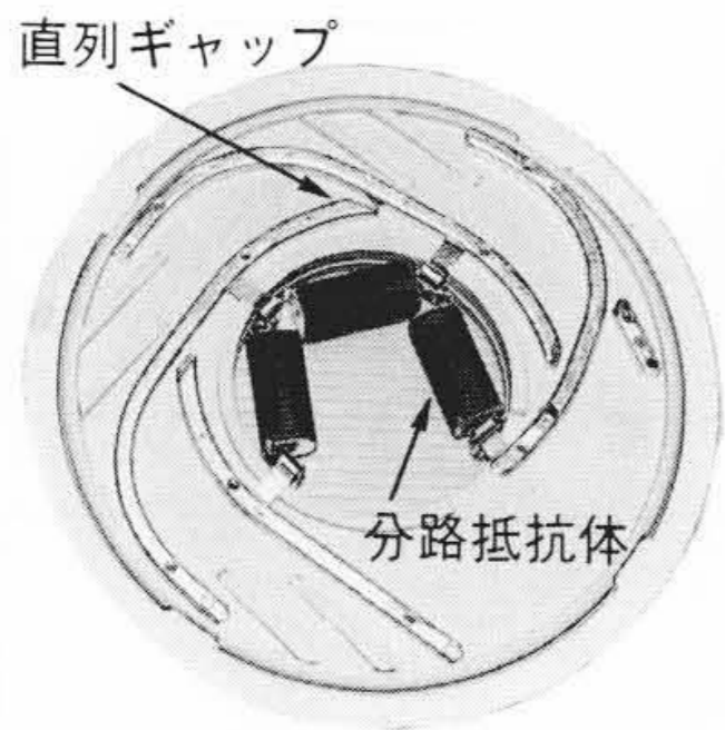
直列ギャップ部の内部構造 (分路抵抗体)
