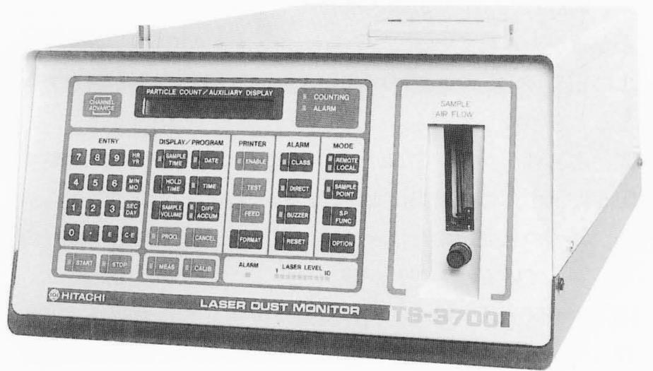
図2 TS-3700外観 最小可測粒径0.1 μm, 吸入量28 l/min, フラットキー スイッチを使用し、豊富な処理機能を実現した。
