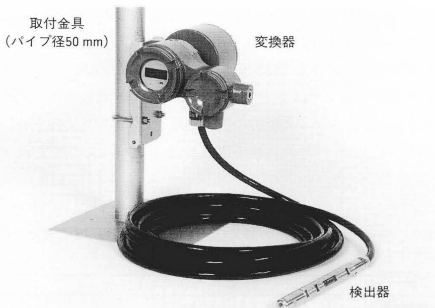
図6 インテリジェント水位計の外観 通信機能を用いることによって、検出器を水に入れたままで基準レベルの調整やレンジ変更ができるようになった。
