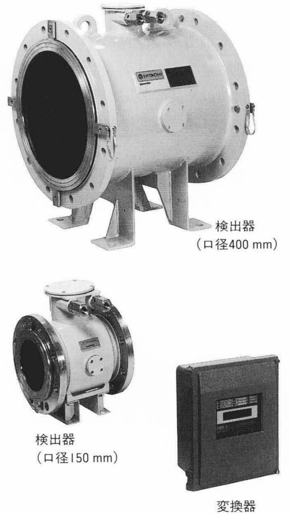
図3 FMR-8形電磁流量計 ELMAGシステムを用いて開発した検出器で、流れの影響を最小にする磁界構造が採用されている。従来品に比べて面間寸法が $\frac{1}{2} \sim \frac{2}{3}$ に短縮され、小形・軽量化が図られている。
