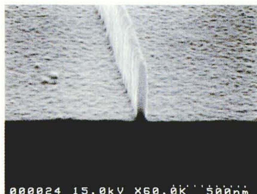
HL-700F IIによる0.05 \mu\text{m} 解像例
