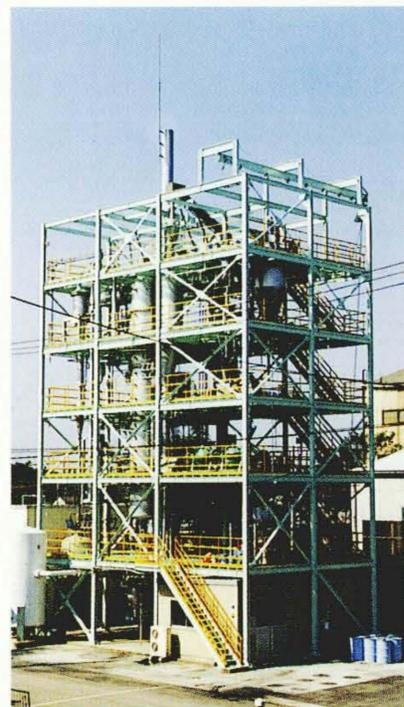
加圧流動床ボイラ総合試験設備
