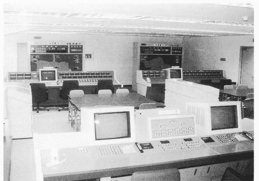
図5 ダム操作訓練シミュレータ外観 訓練室内の観で、手前がトレーナー卓、奥の2セットが受講者卓である。
