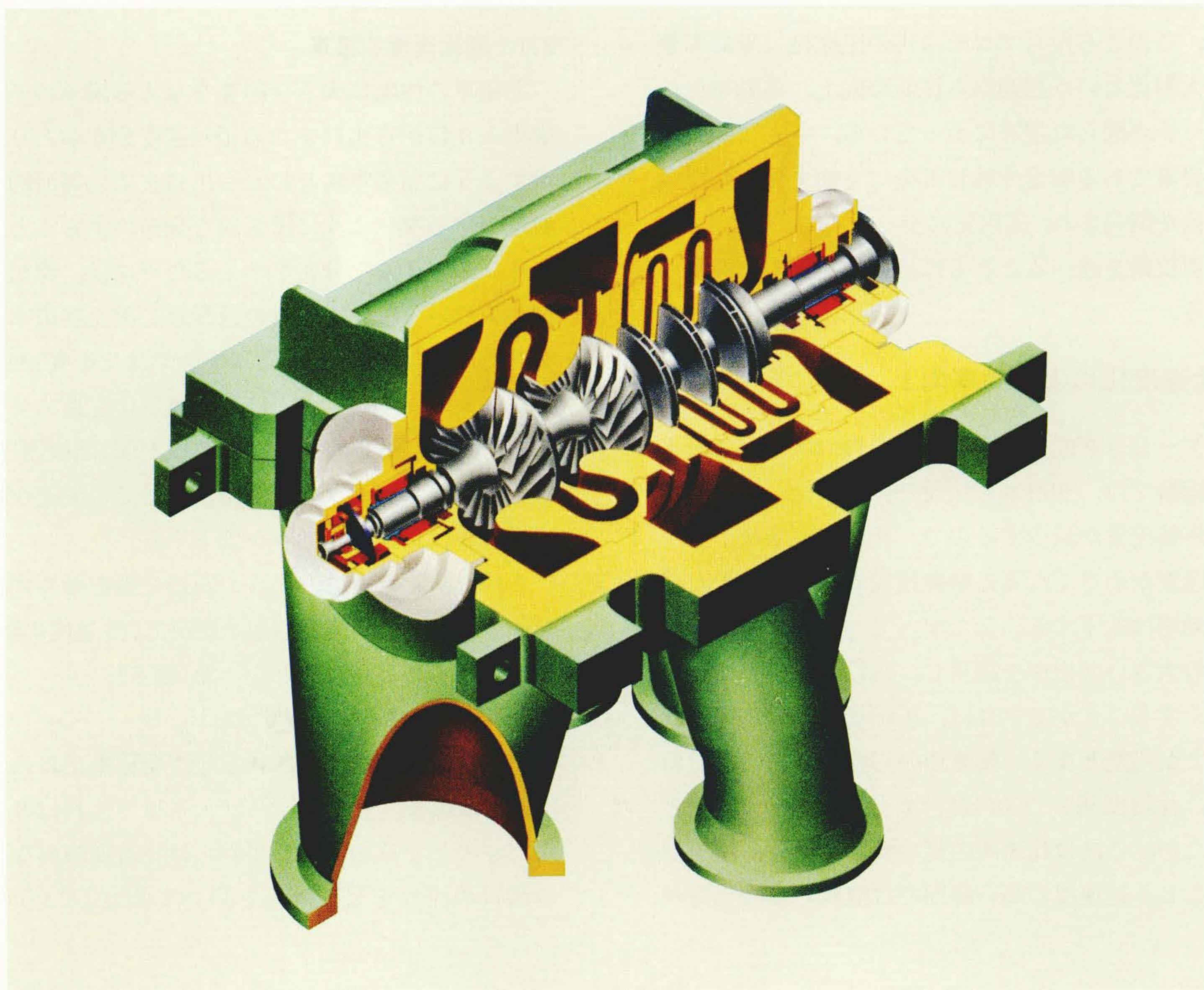
高比速度羽根車搭載オイルレス圧縮機 斜流羽根車を前段に搭載し、磁気軸受、非接触ガスシールの活用によってドライ化を可能とした。
