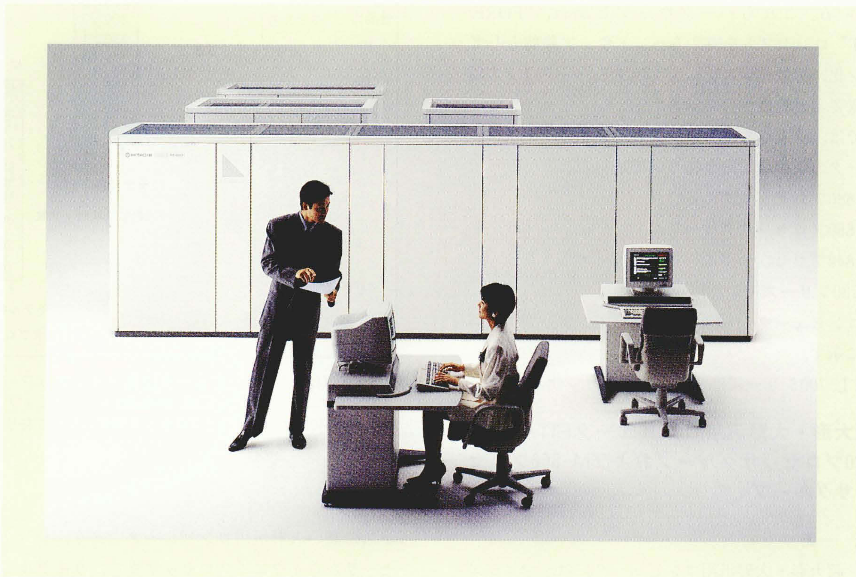
HITAC M-880プロセッサグループ HITAC M-880は命令プロセッサ台数1～6のモデル分けになっている。写真は命令プロセッサ台数3であるモデル310を示す。
