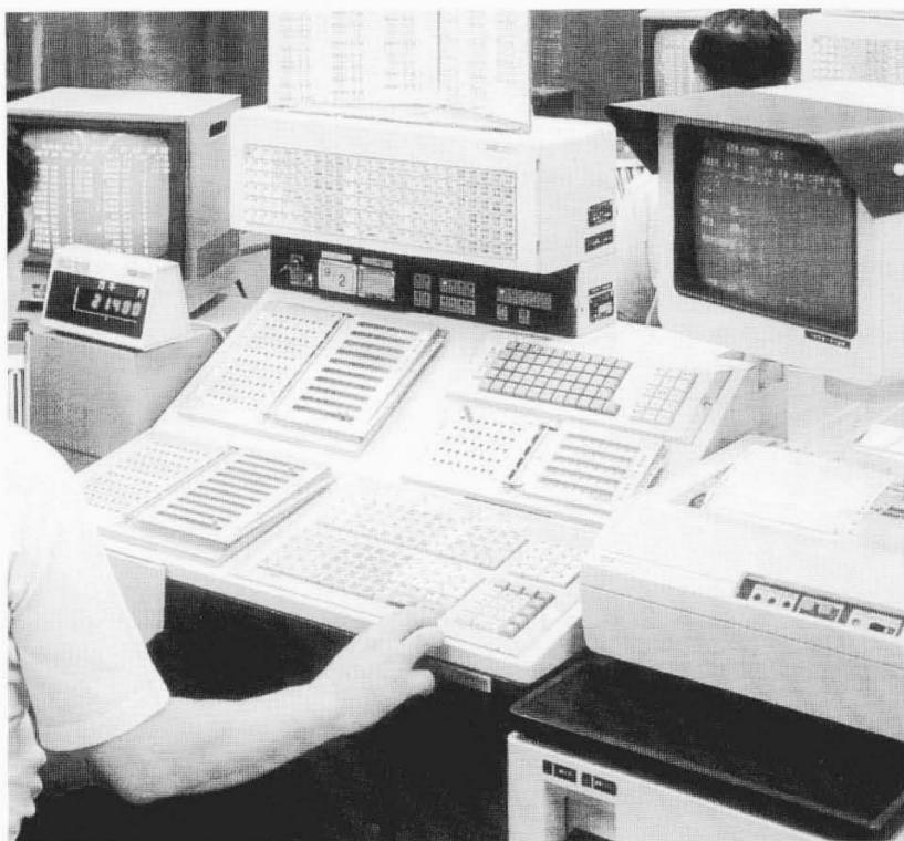
図1 座席予約・発券端末 「みどりの窓口」では係員が端末を操作して、指定券・乗車券を発売している。
