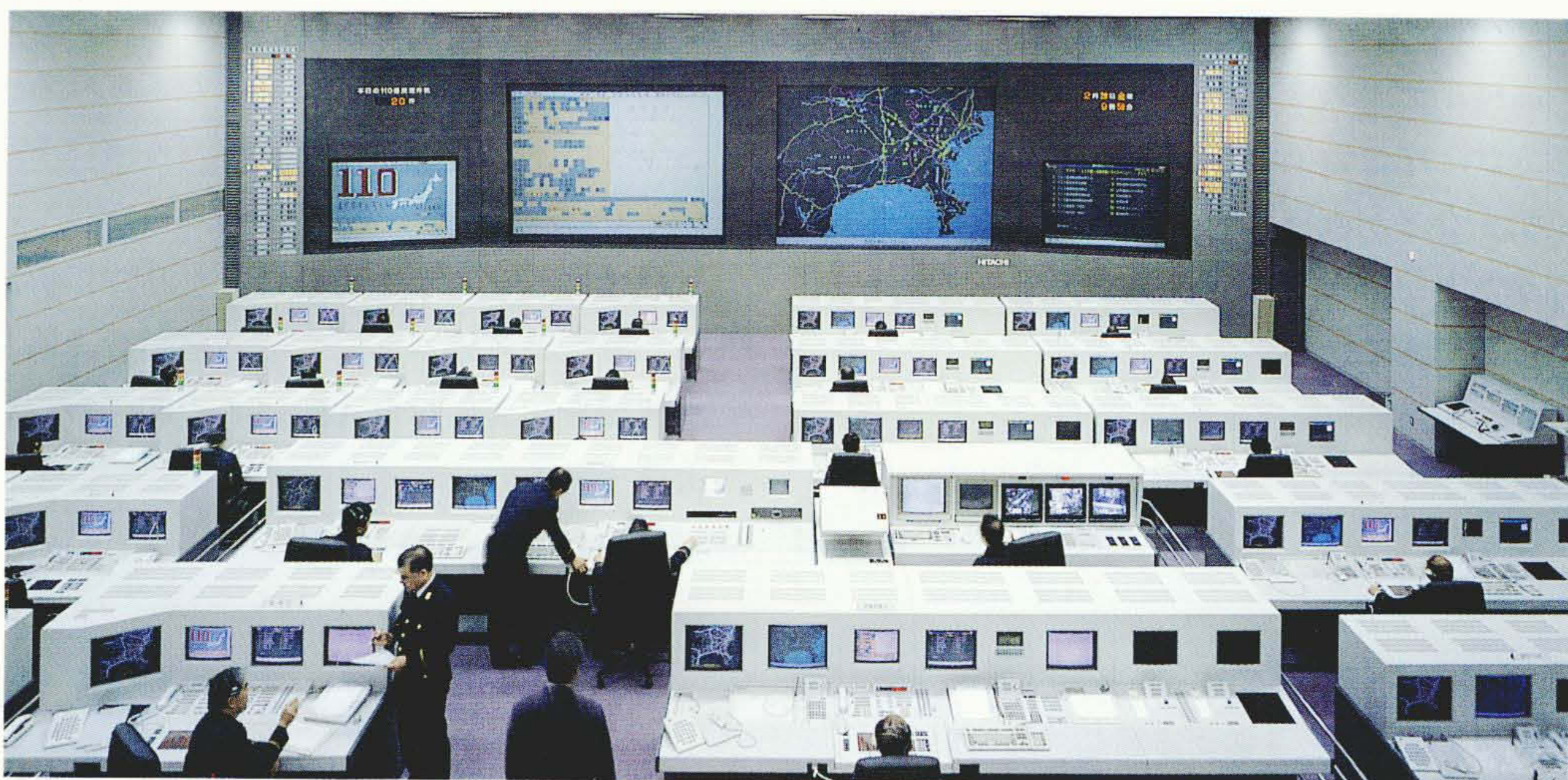
図2 神奈川県警察本部通信指令室 200形、110形ディスプレイを各2面ずつ配置し、多重配備への対応などで多様性のあるシステムとしている。
