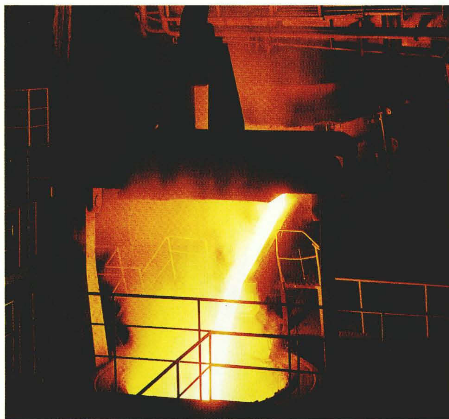
図1 日立金属株式会社安来工場で40トン電気炉から誕生する高級特殊鋼「ヤスキハガネ」 販売情報システム“HISPEED”は、「ヤスキハガネ」と特約店、需要家を結ぶ架け橋である。
