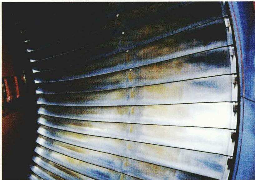
図1 碧南火力2号機40インチ長翼の外観 エロージョン発生状況は、従来の33.5インチ長翼の場合と同程度であることが確認できた。
