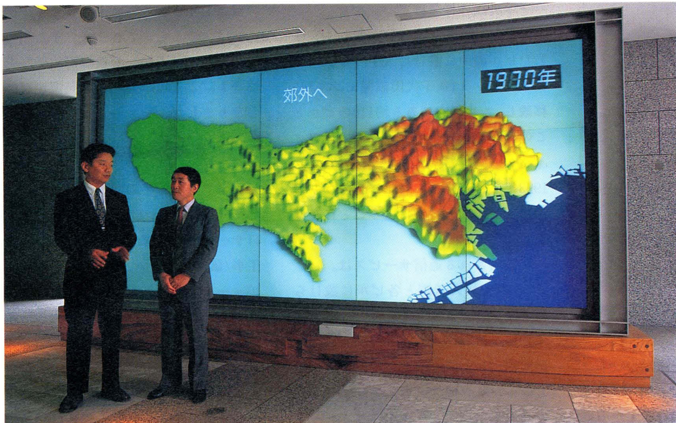
東京都庁第一本庁舎1階の自治展示ホールに設置されたマルチスクリーンシステム。背面投写型ディスプレイ技術によって、明るい場所でも鮮明な画質を実現した。 [人物は左から情報映像メディア事業部映像システム部の新見博英主任技師と、同映像システム設計部の船川克夫部長]
