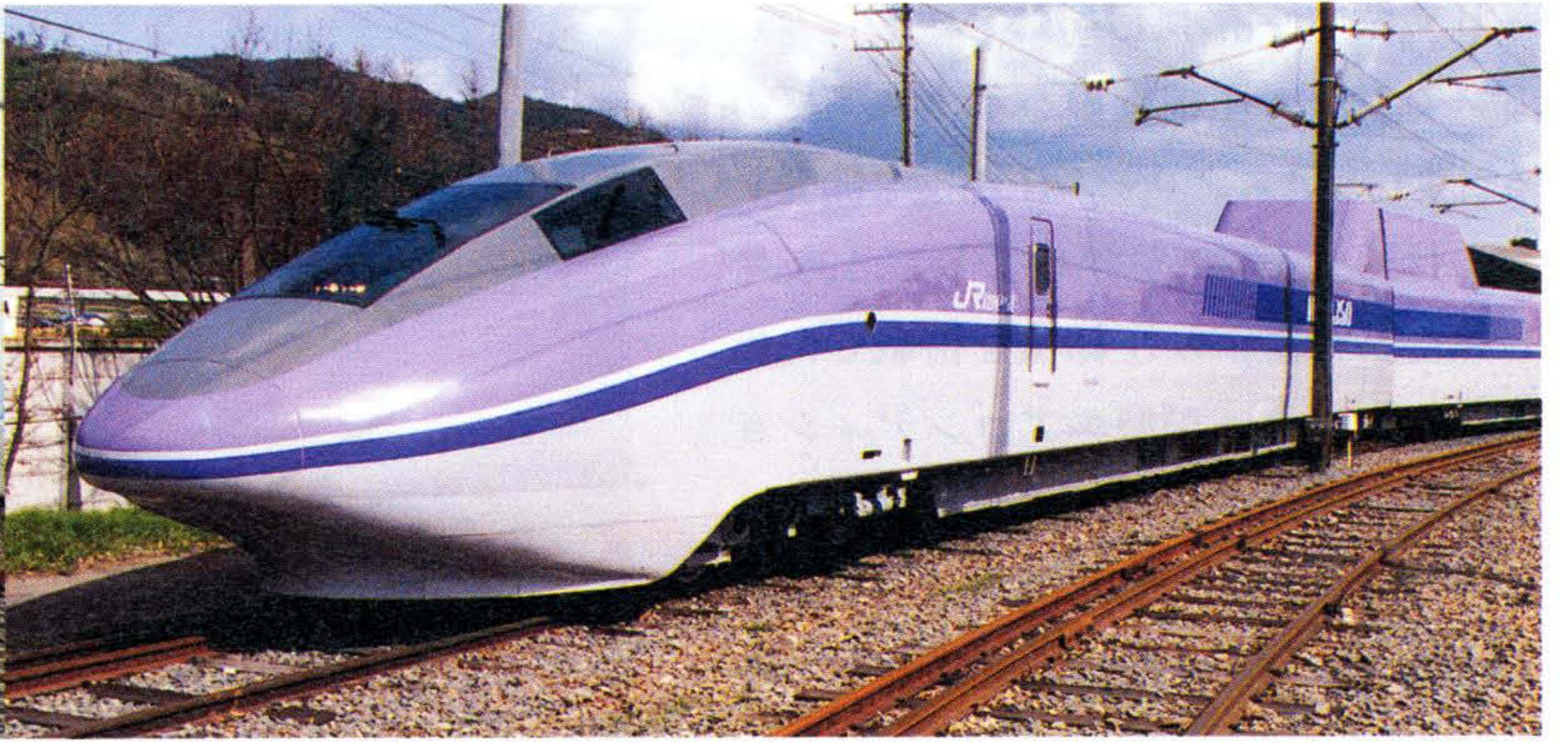
滑らかなボディラインと鋭角的な先頭形状が特徴的な山陽新幹線の次世代新幹線用高速試験電車「WIN350」(西日本旅客鉄道株式会社)。
