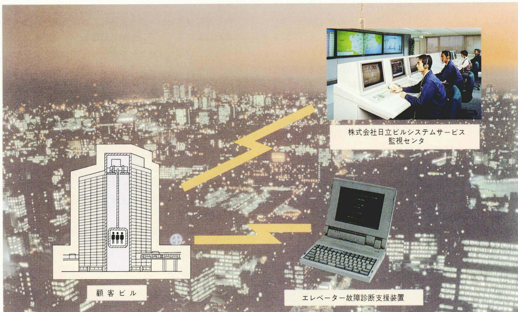
**エレベーター遠隔知的診断システムの概要** 公衆電話回線を経由して、エレベーターの診断や故障診断支援を行う。
