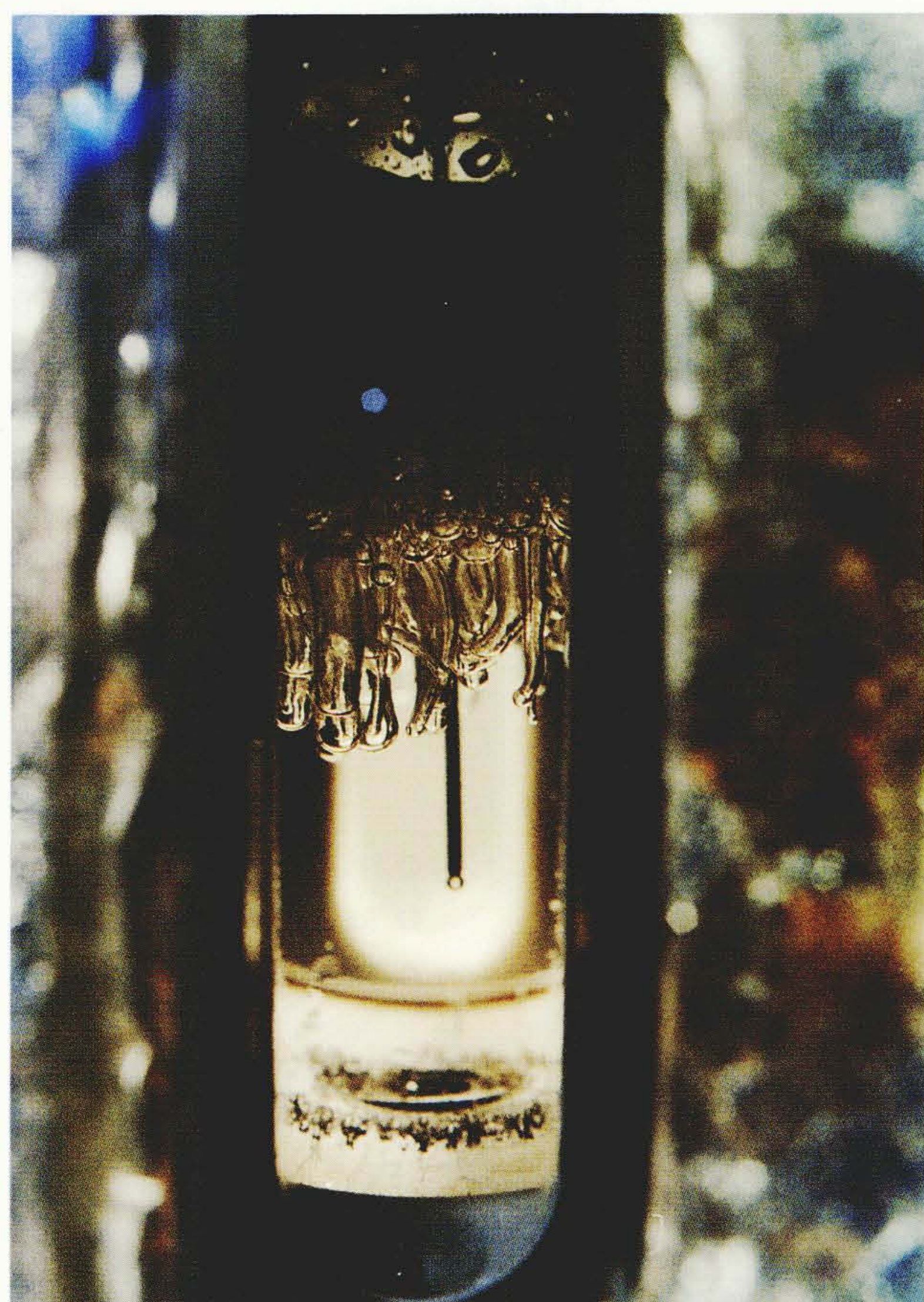
図3 CO 2 ハイドレートの生成状況 500 mの深海を模擬した50 kg/cm 2 の圧力下に液化炭酸ガスを吹きこむと、つらら状に成長したハイドレートが生成することを確認した。
