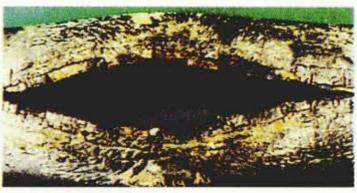
過熱器管の長時間クリープ割れ (約15万時間経過後の例)    | <ul style="list-style-type: none"> <li>過熱器管</li> <li>再熱器管</li> </ul>                                              |
