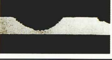
つり下げ再熱器ベンド部の孔食 (約14万時間経過後の例)  | <ul style="list-style-type: none"> <li>再熱器管</li> </ul>                                                            |
