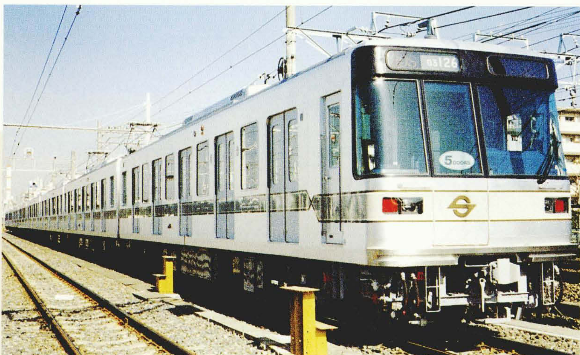
IGBTインバータを搭載した帝都高速度交通営団日比谷線の03系電車。写真上の長円形の部分が、インバータ搭載箇所。4台のインバータが搭載されており、1台あたり24個のIGBTモジュールが使われている。
