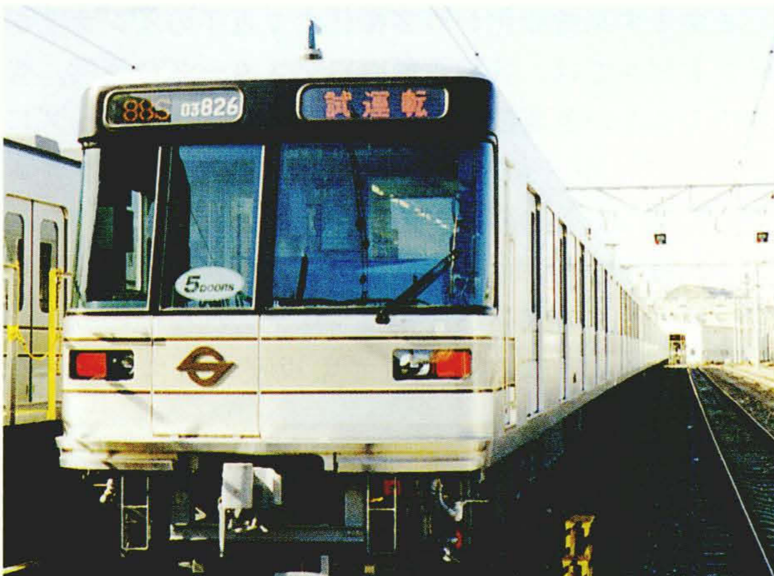
IGBTインバータを搭載した03系電車
