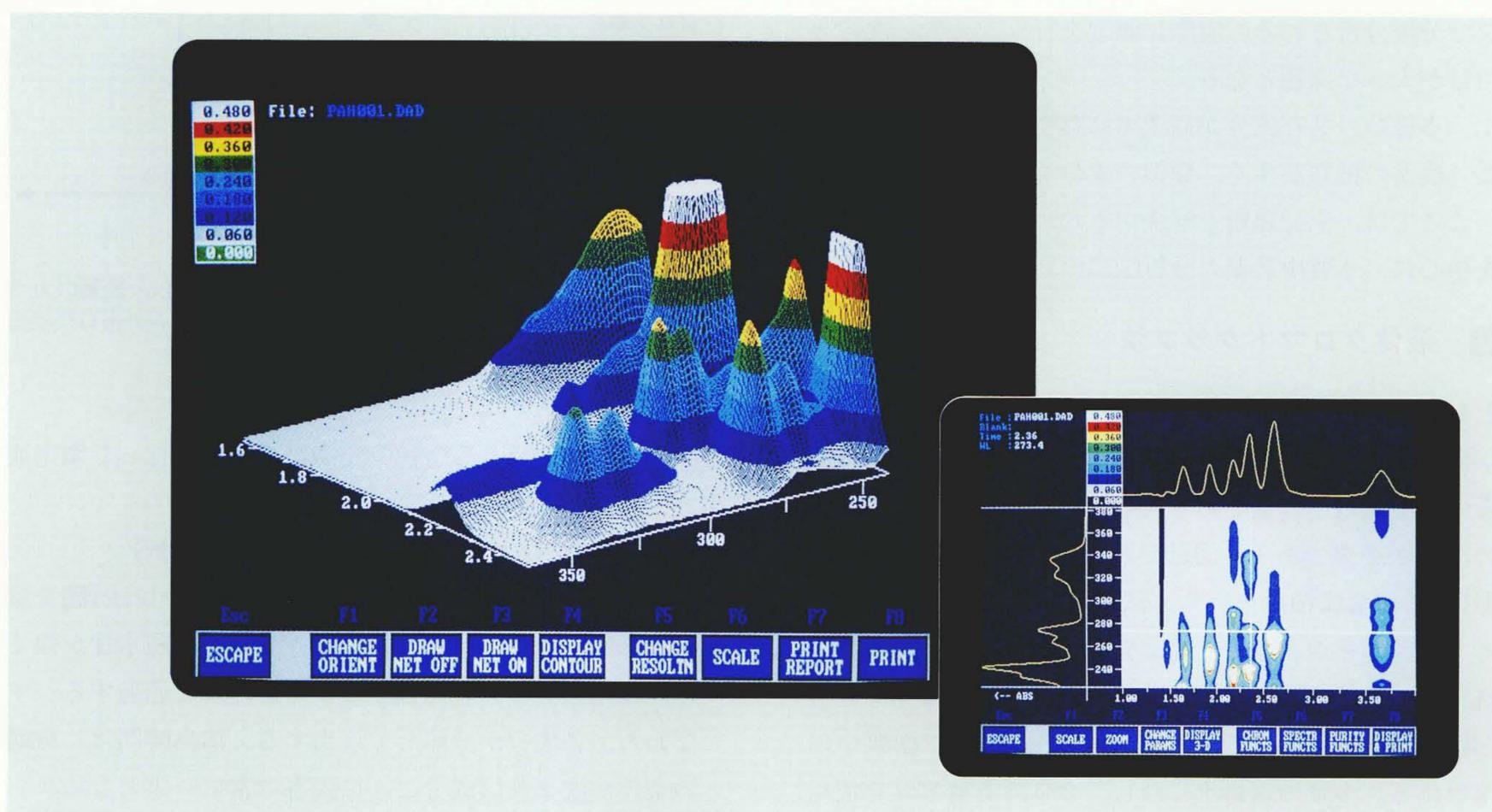
**多波長同時検出器(三次元クロマトシステム)** 液体クロマトグラフの検出器としてフォトダイオードアレーを採用した多波長同時検出器では、吸収スペクトル情報を常時得ることができる。共存物による妨害ピークがある場合でも、測定対象の農薬に固有な吸収スペクトルで確認を行うことにより、分析結果の信頼性を高めることができる。この図では波長、溶出時間および信号値(吸光度)を三次元表示している。
