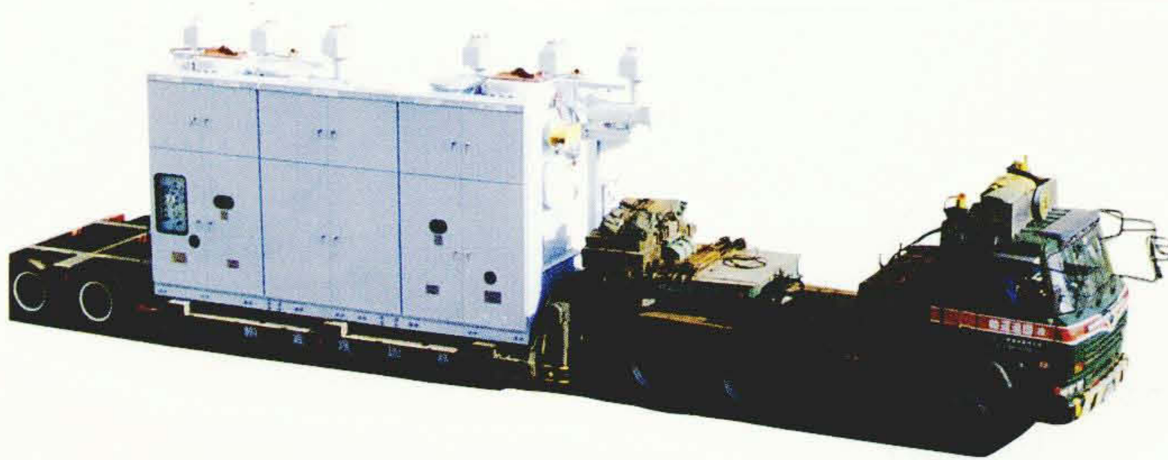
図2 パッケージ型ガス絶縁開閉装置 ガス絶縁開閉装置の縮小化により、一体輸送が可能である。
