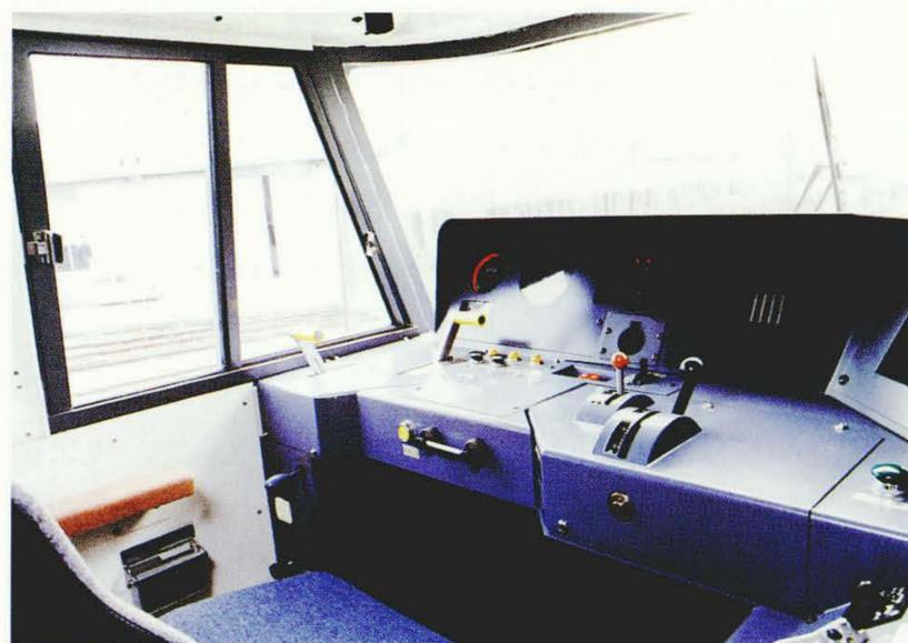
図9 運転台の外観 運転席の右手に主幹制御ハンドルを，左手にブレーキ操作ハンドルを配置し，前面パネルには速度計，圧力計，けん引力計，表示灯およびカラー液晶ディスプレイを配置している。
