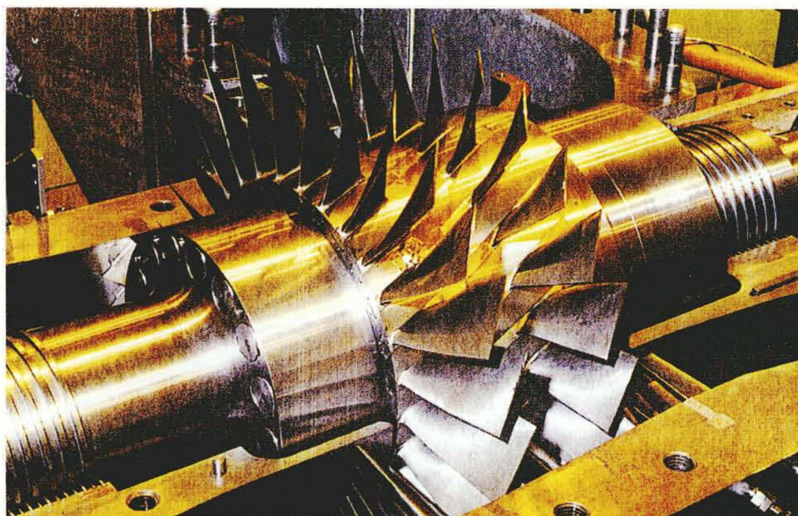
図6 遷音速軸流圧縮機の回転試験装置
