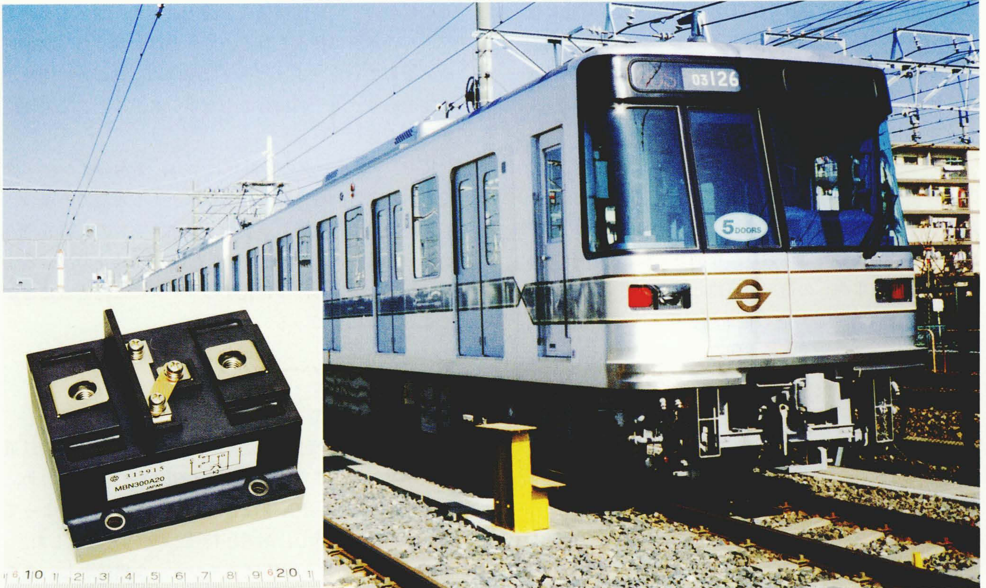
IGBTインバータを搭載した帝都高速度交通営団日比谷線03系電車とIGBTモジュール(左下)
