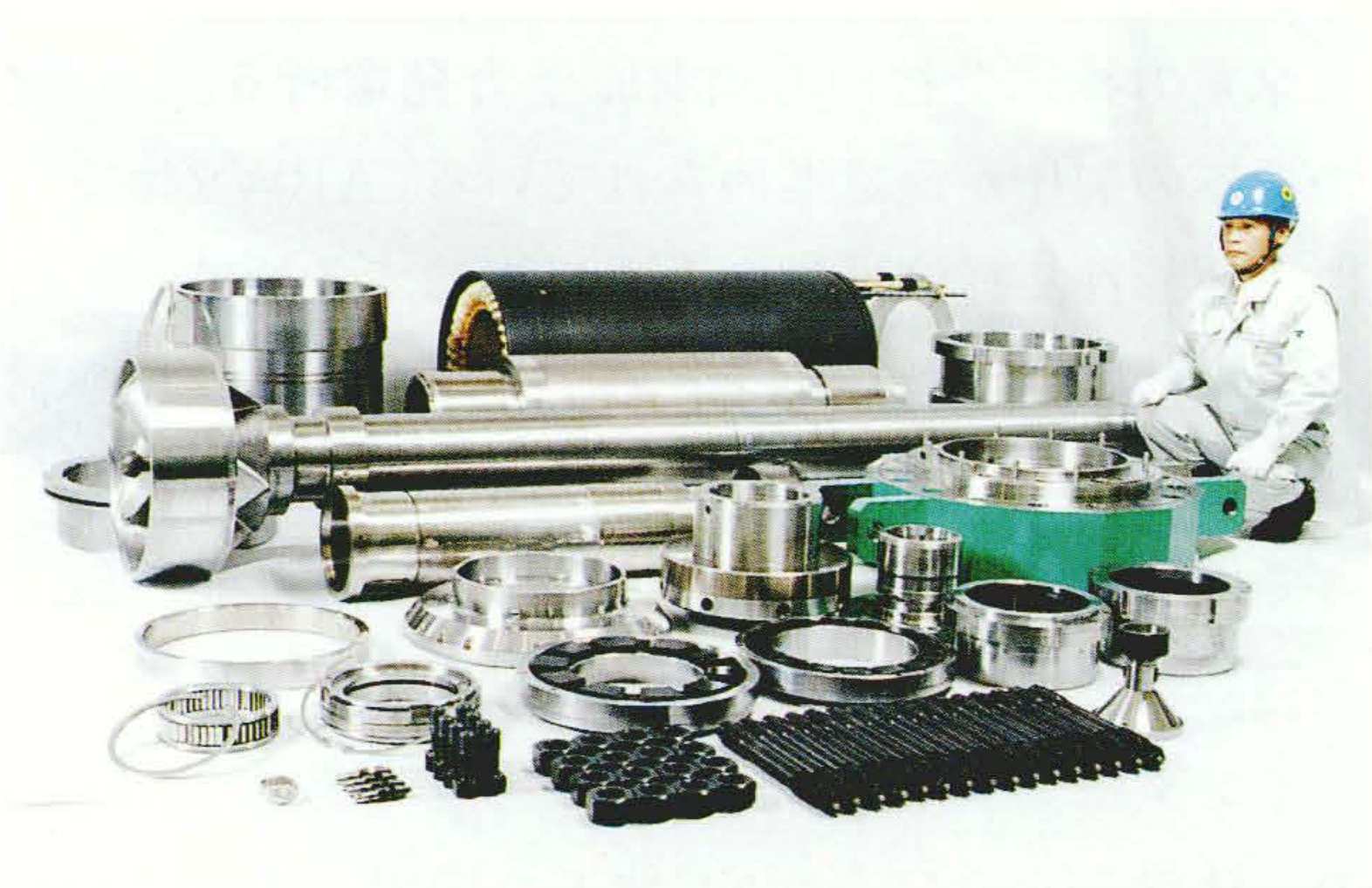
図1 インターナルポンプの各構成部品 どの構成部品に対しても耐久性,作業性を十分考慮した設計としている。
