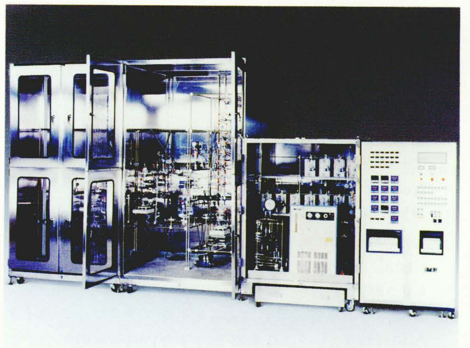
図4 濃縮・酸回収・精留プロセス評価試験装置 さまざまな核種の揮発やミストによる移行量を評価して、蒸発缶での放射性核種の除去性能を確認する。
