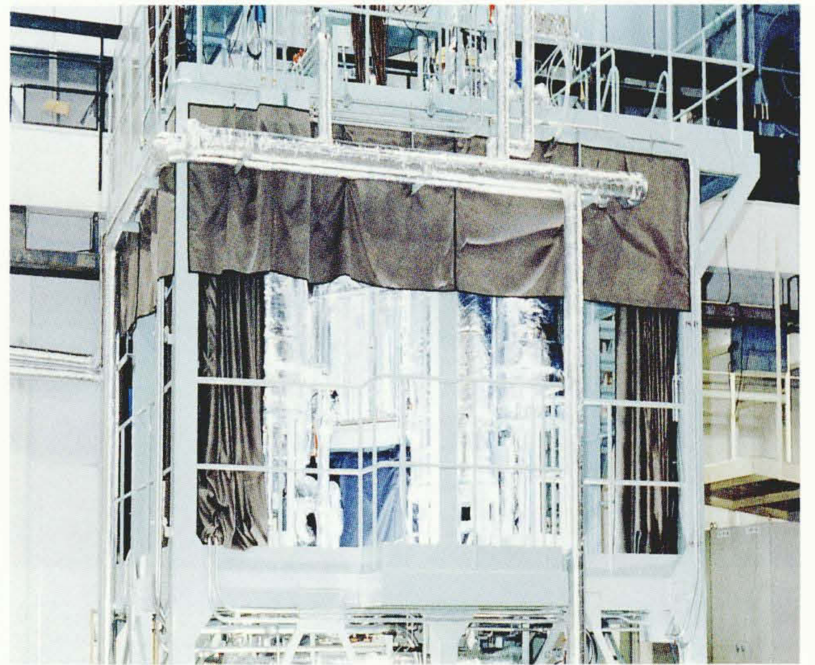
図 2 実証炉 1 号の一次系全体水流動試験装置
