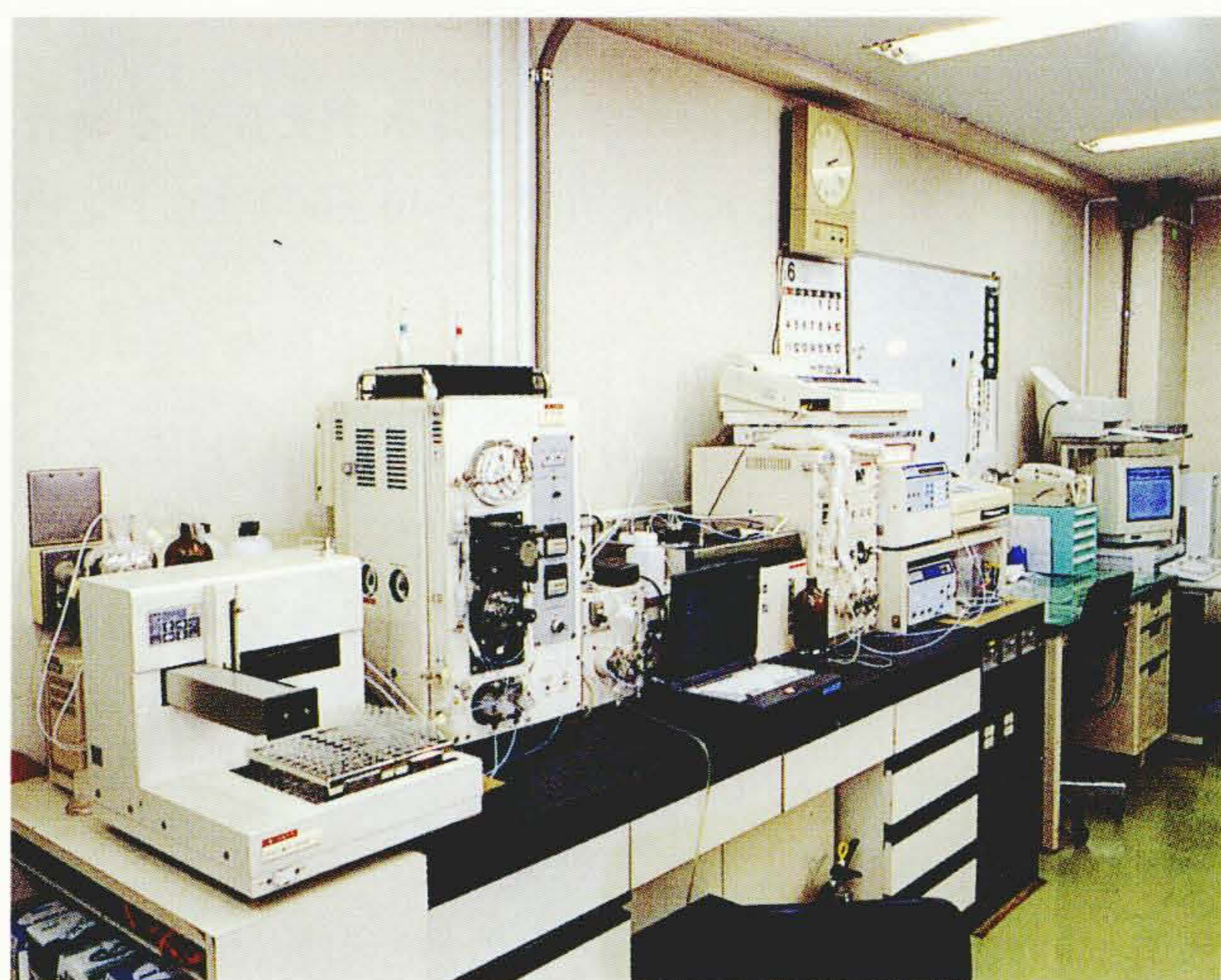
図4 全自動溶液分析システム 定期的にサンプリングした溶液を全自動で分析する。
