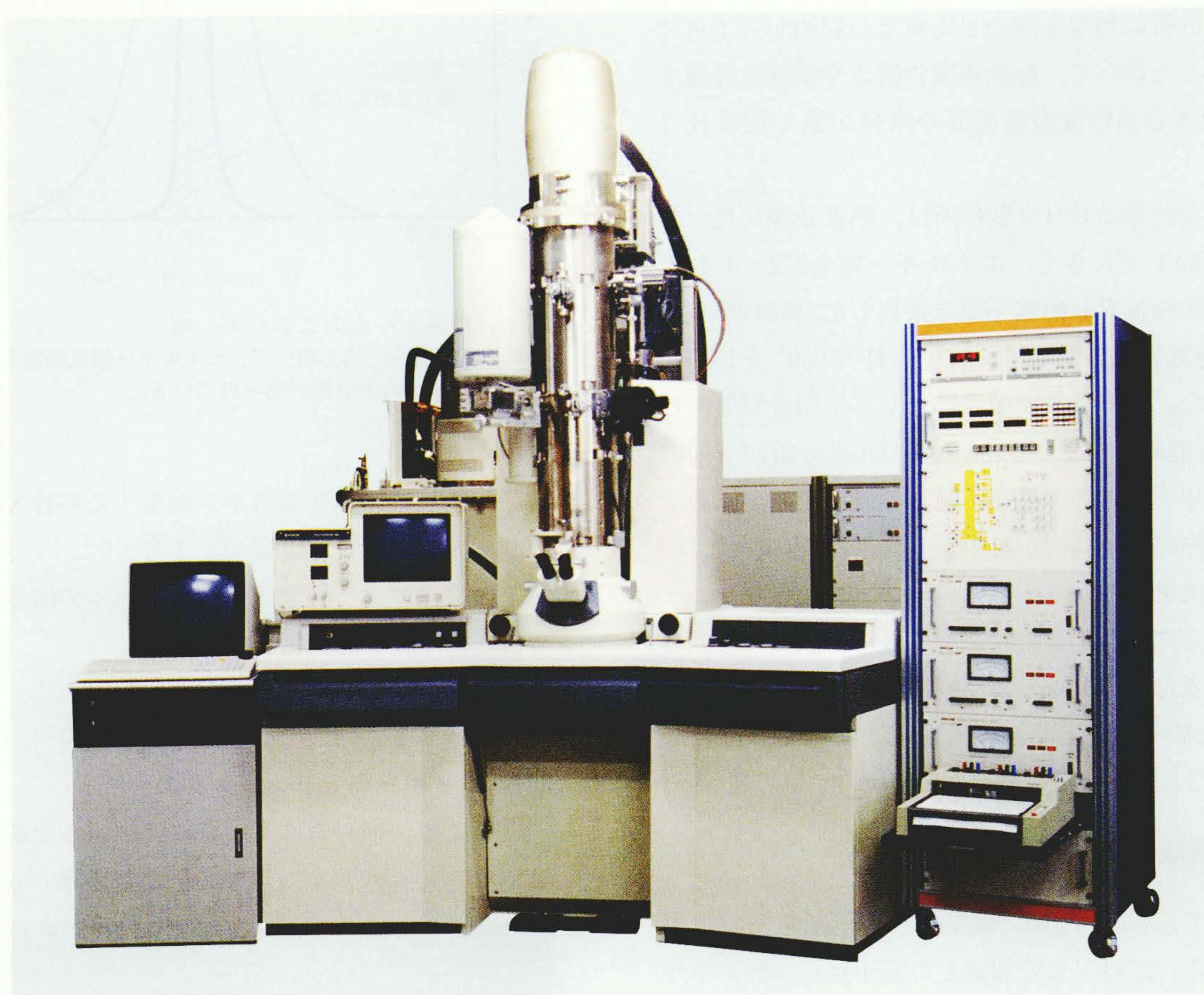
300 kV冷陰極電界放出型分析電子顕微鏡
