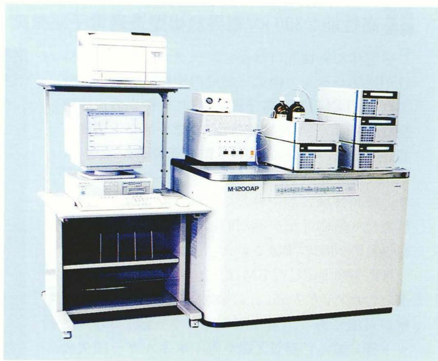
中性粒子の除去によってさらにSN比を向上させたLC/MSシステム「M-1200AP」
