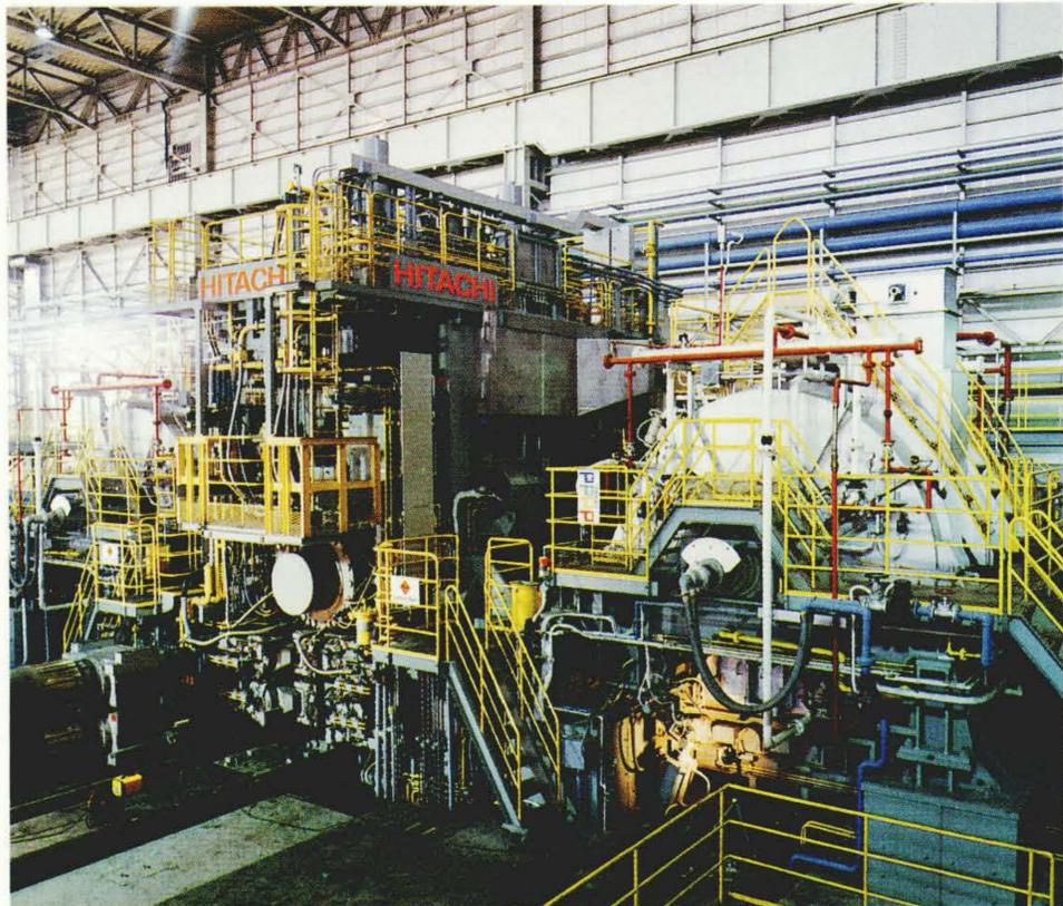
日本冶金工業株式会社納めステッセル圧延設備仕上ミル(HCXタイプ)
