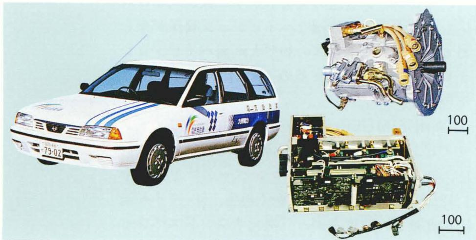
「アベニールEV」車(左)と、搭載された誘導電動機(右上)およびインバータ(右下)
