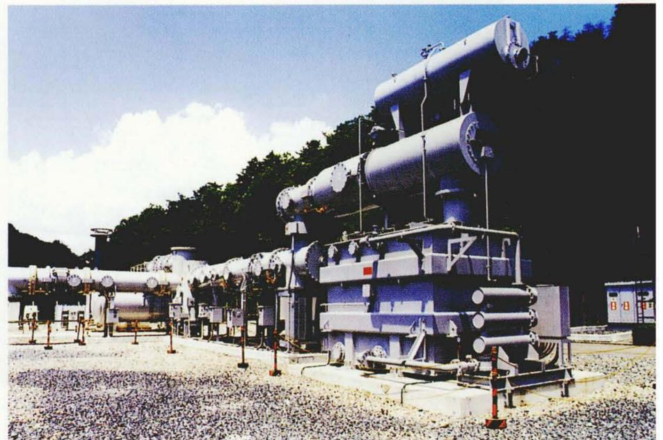
関西電力株式会社山崎実験センターにおけるプロトタイプ器。1年間で約30年間分の寿命を確認するための課電・加速試験を行った。
