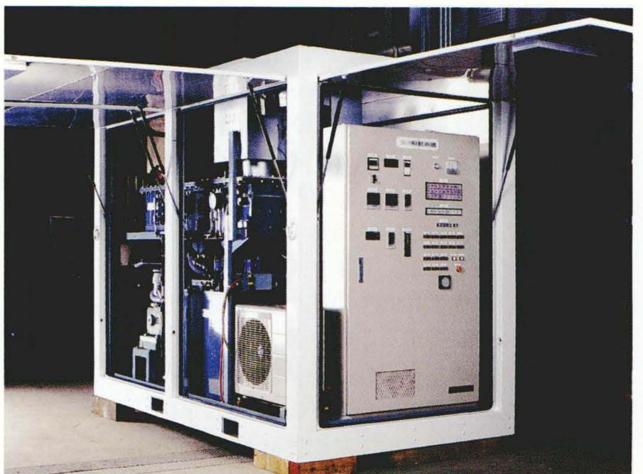
触媒方式フロン分解装置。触媒方式の採用により、約400℃でフロンを分解する。廃液処理も含め、小型パッケージ化を図っている。
