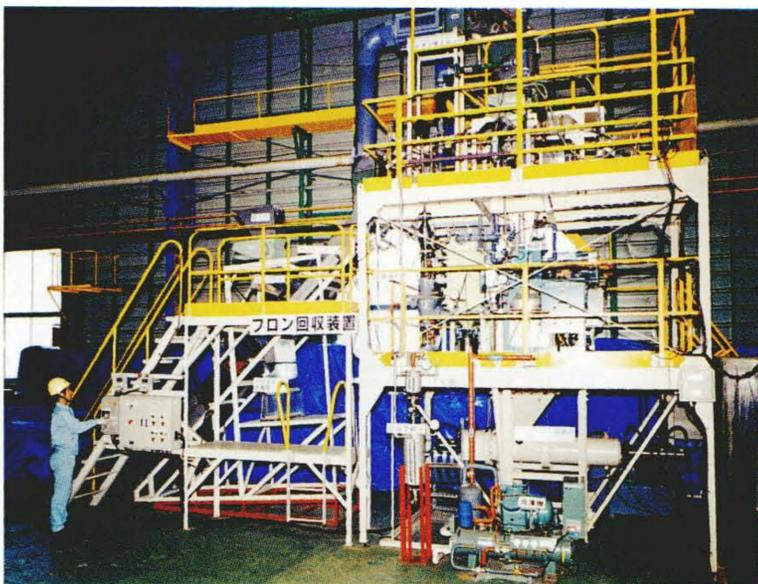
断熱材フロン回収プラント。断熱材を微粉碎し、その中に含まれるフロンガスを取り出したあと、凝縮させて回収する。(財)家電製品協会より実証研究設備を受託し、現在、稼動中。
