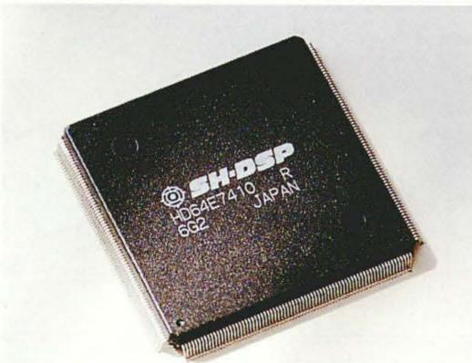
汎用性、高級言語、OSに対応するSHマイコンに、高速信号処理を行うDSPを融合して1チップ化させたコンパクトなSH-DSP(チップ外観写真)。
