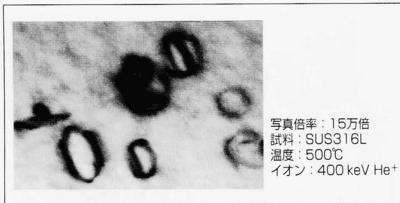
図3 透過型電子顕微鏡による照射欠陥観察像
