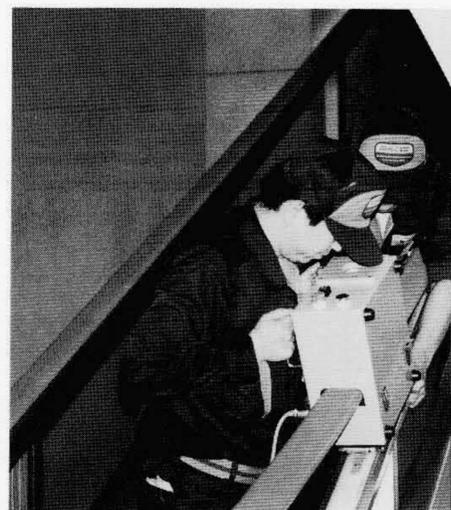
図6 小型X線探傷装置による診断作業
