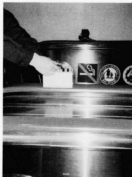
図5 ハンドレールチェッカによる診断作業
