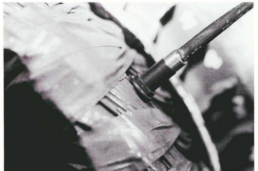
図2 回転機絶縁の熱劣化診断装置の検出部
