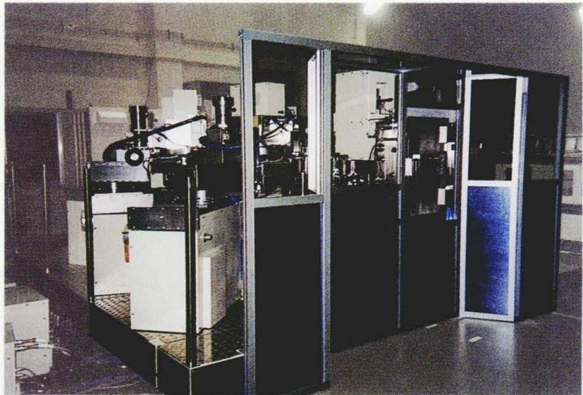
超薄多層GMR膜形成用クラスタ型スパッタ装置
