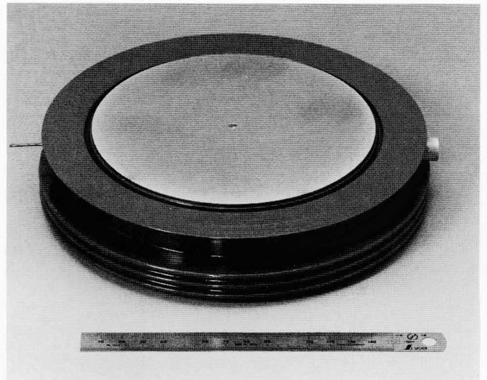
図2 8 kV 3,500 A光直接点弧サイリスタ素子
