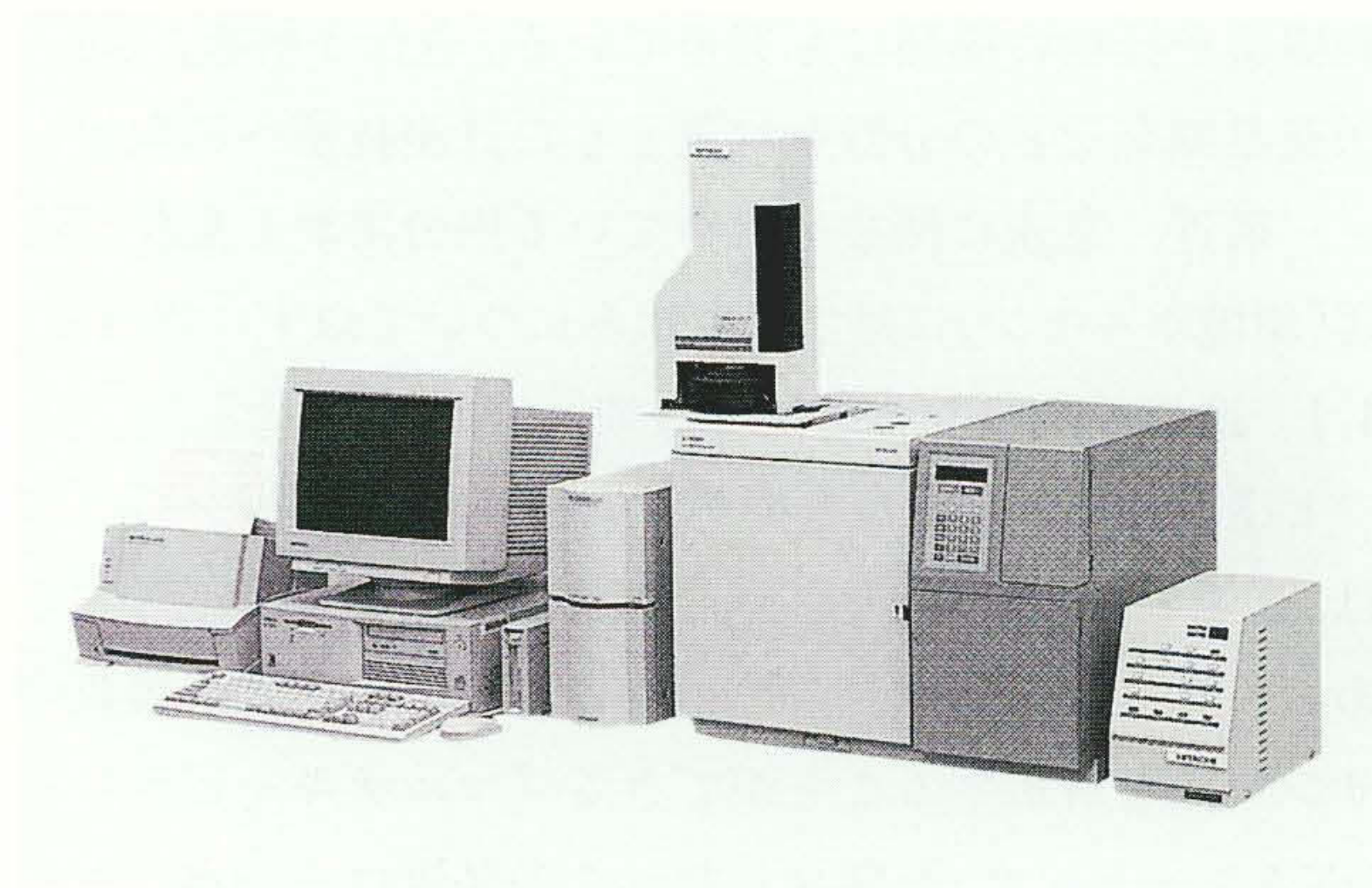
図4 内分泌かく乱化学物質の分析などに用いられるGC/MSの外観
