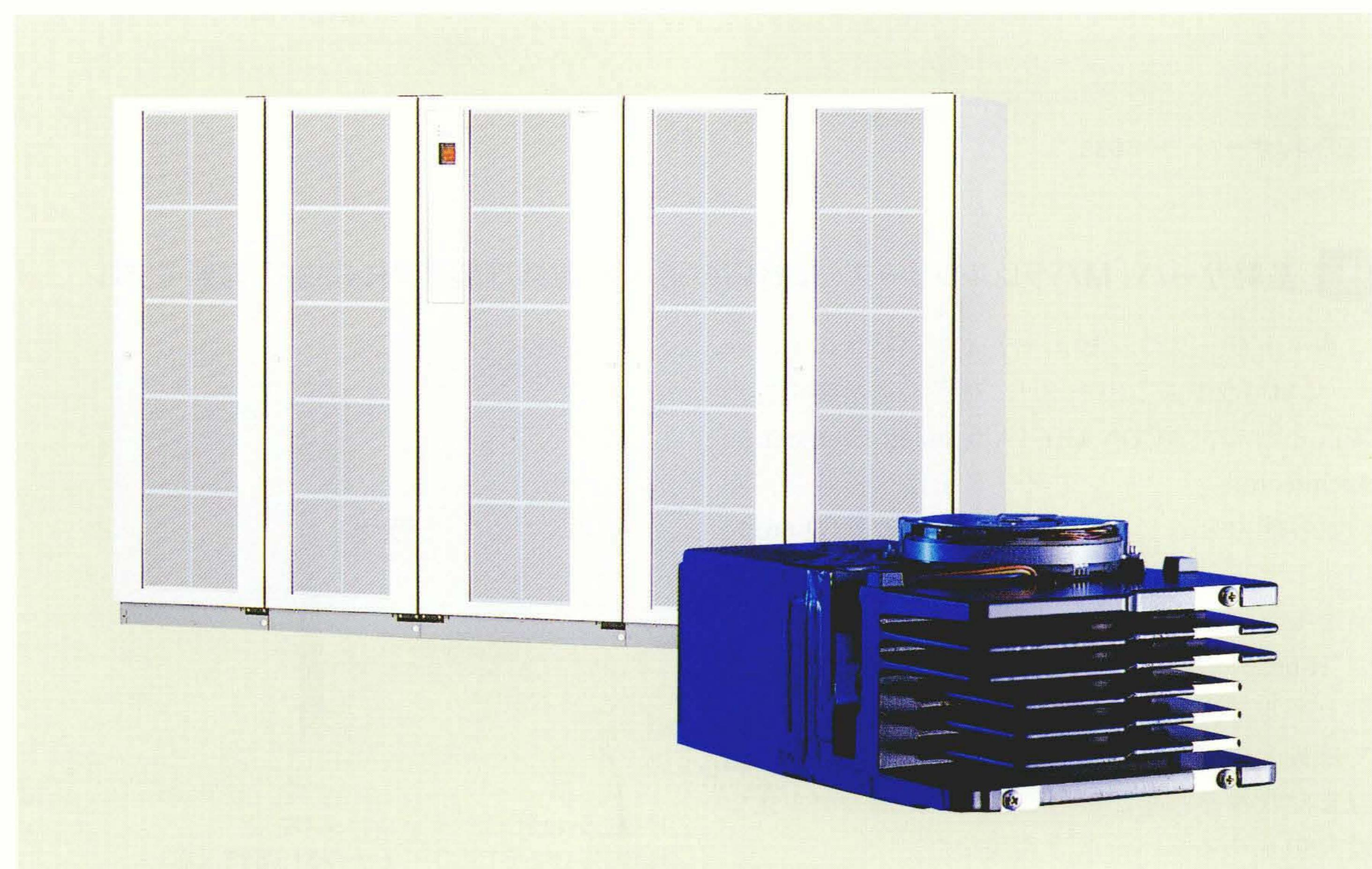
世界最高速6 Gバイトディスクドライブ用「RAID300ディスクアレイサブシステム」
