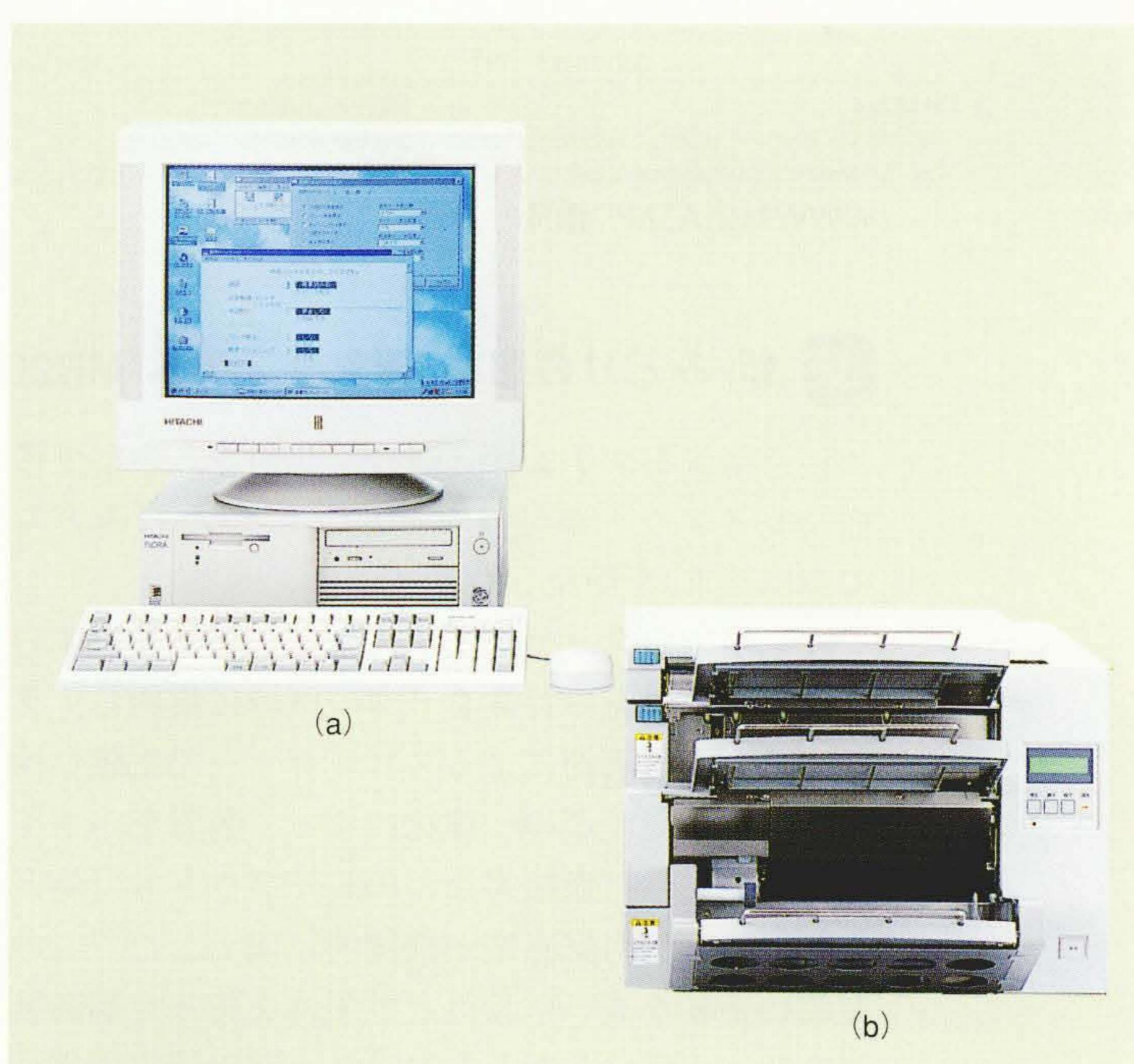
パソコン上の“Imaging-OCR”動作画面(a)と、OCR専用スキャナ(b)
