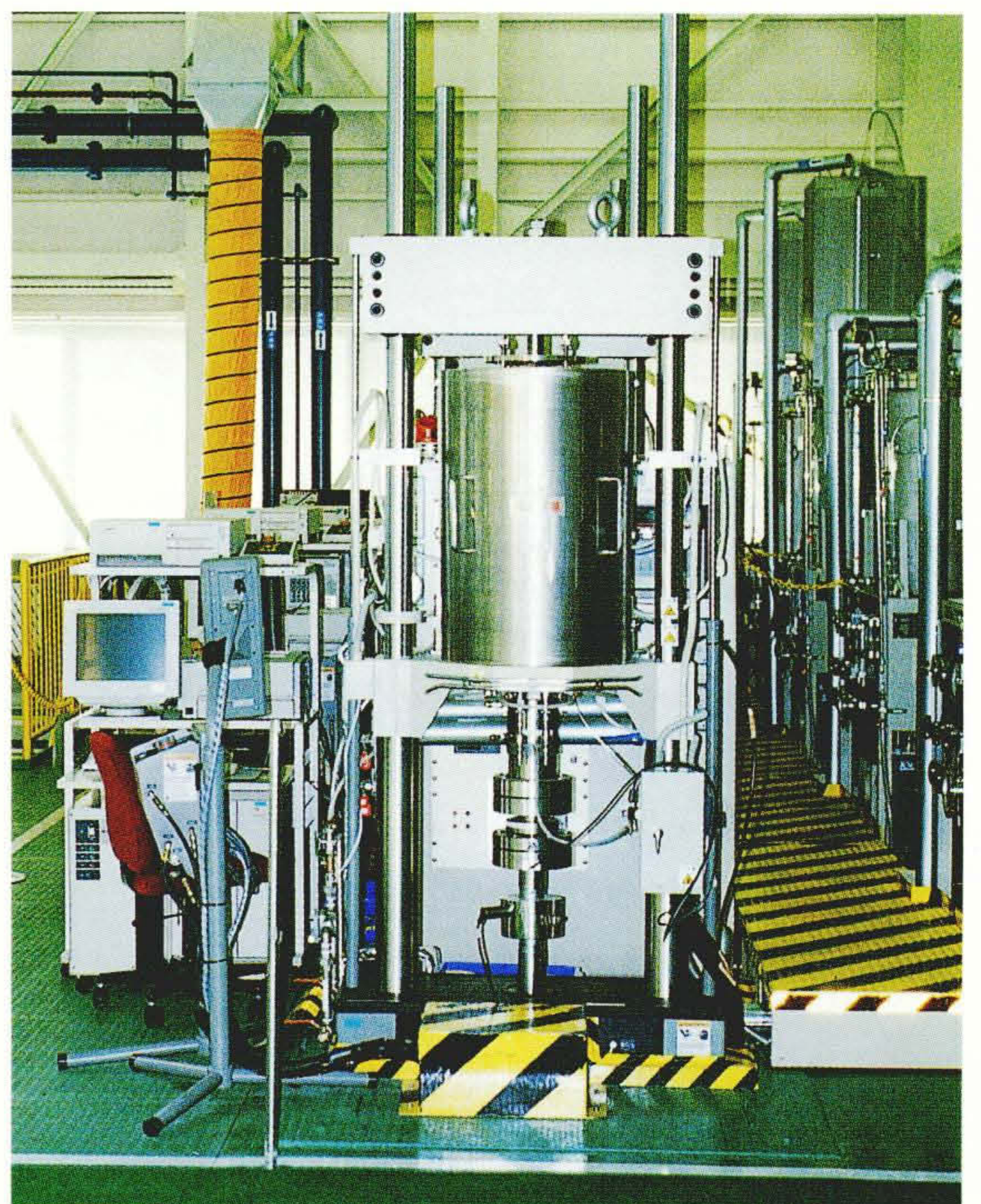
財団法人発電設備技術検査協会納め BWR環境中の疲労試験装置
